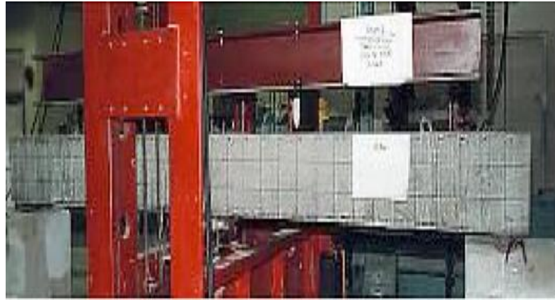
Şekil 3.14 3 metre uzunluğunda jeopolimer karbon kompozit beton kiriş (Davidovits, 2002)
