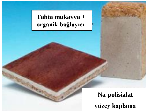
Şekil 3.18 Na – Polisialat ile kaplanarak üretilmiş yangına dirençli tahta mukavva (Davidovits, 2002)
