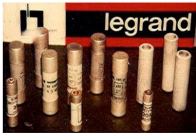
Şekil 3.20 Siliciface cor 70 adıyla tescilli jeopolimer malzemeden üretilmiş elektrik sigortaları (Davidovits, 2002)
