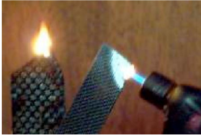
Şekil 3.8 Karbon/epoksi (solda) ve karbon/jeopolimer (sağda) kompozit malzeme (Davidovits, 2002).
