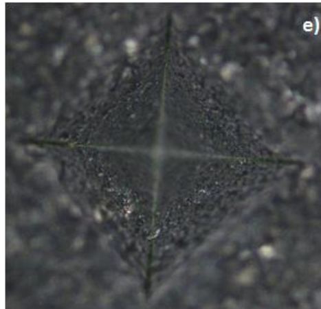
Fotoğraf 4.3. 50, 100, 300, 500 ve 1000 gr yük uygulanması ve \times 5 , \times 10 , \times 20 , \times 50 , \times 100 büyütmesinde çekilen T3 numunesi ait metalografik fotoğraflar
