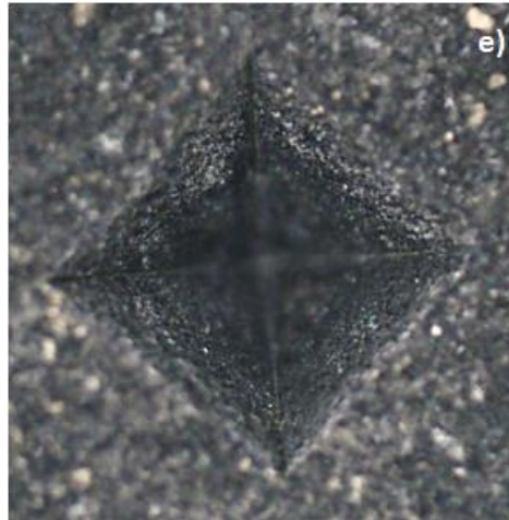
Fotoğraf 4.4. 50, 100, 300, 500 ve 1000 gr yük uygulanması ve \times 5 , \times 10 , \times 20 , \times 50 , \times 100 büyütmesinde çekilen T4 numunesi ait metalografik fotoğraflar
