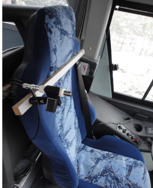
Şekil 7.2 : Mikrofonun koltuğa yerleştirilmesi.
