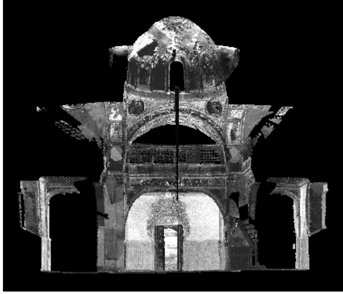
Şekil 4.19. Sille Aya-i Eleni Kilisesinin iç kısmının DD' kesiti
