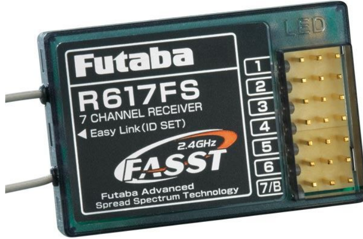
Şekil 3.5. Futaba 7C uzaktan kumanda alıcısı
