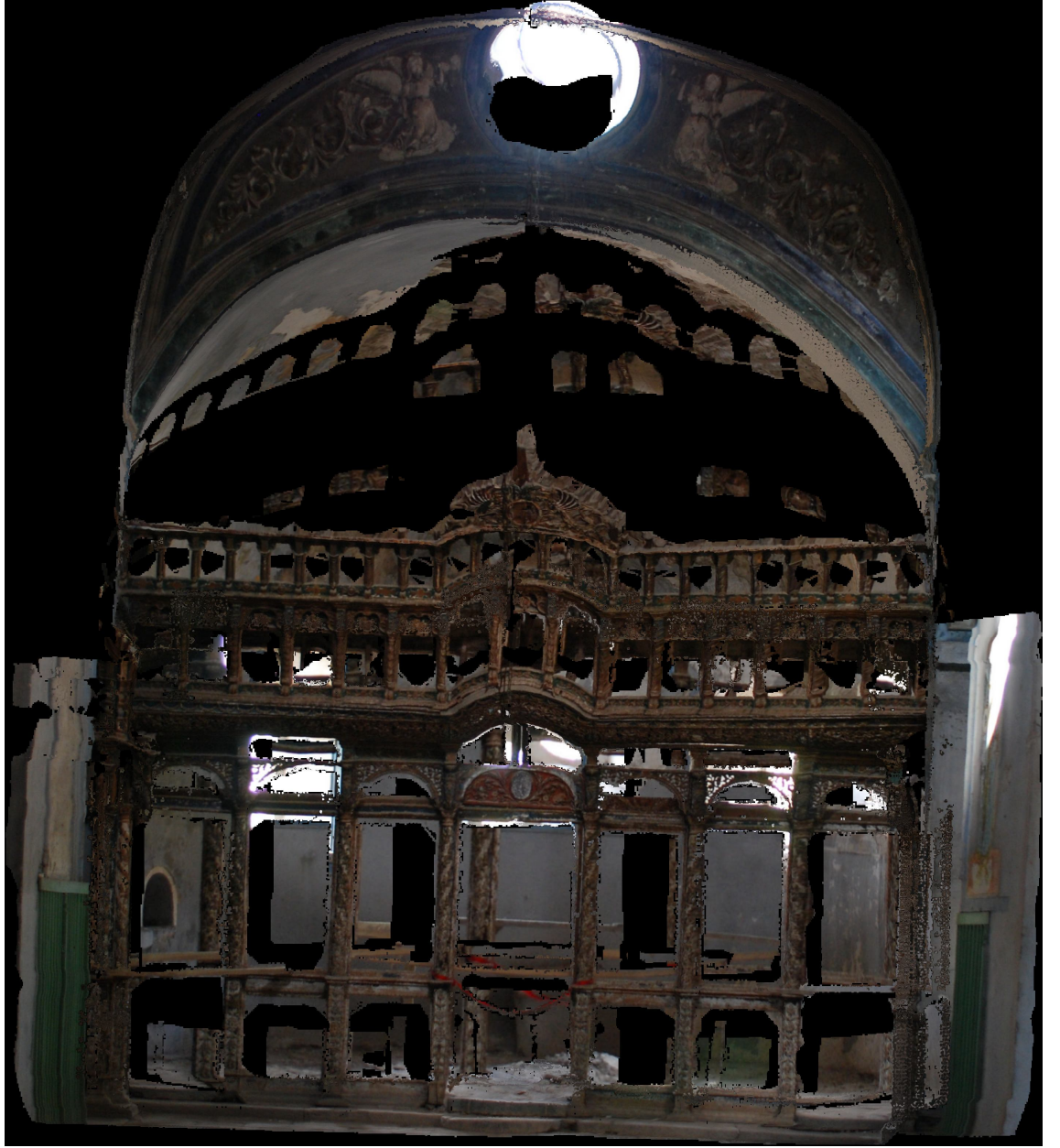
Şekil 4.31. CC' kesitine ait nokta bulutlarından elde edilen ortofoto
