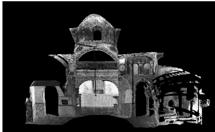
Şekil 4.21. Sille Aya-i Eleni Kilisesinin iç kısmının AA' kesiti
