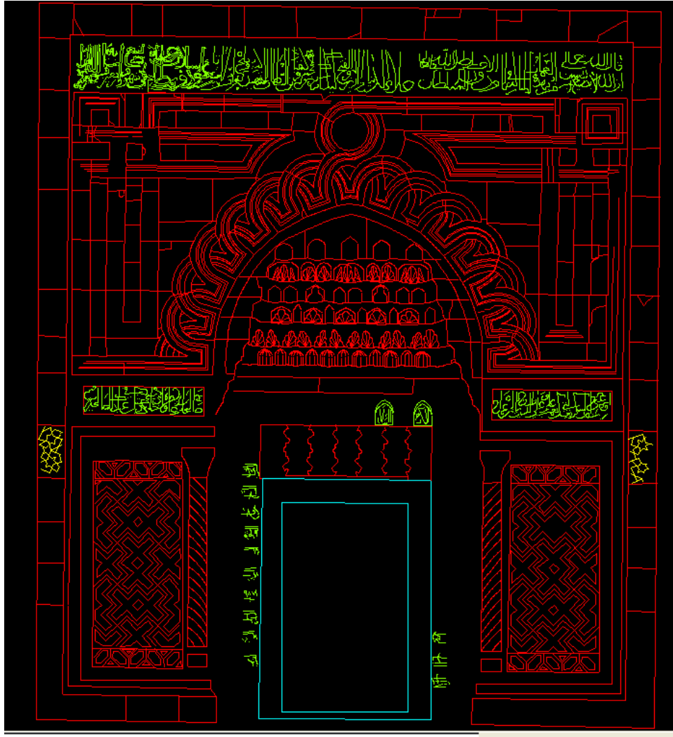
Şekil 4.44. Karatay Medresesi Kapısı nokta bulutlarından çizimi
