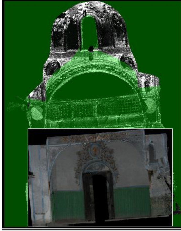
Şekil 4.26. Giriş kısmına ait nokta bulutlarından elde edilen ortofoto
