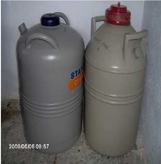
Şekil 3.6. Sıvı nitrojen tankları
