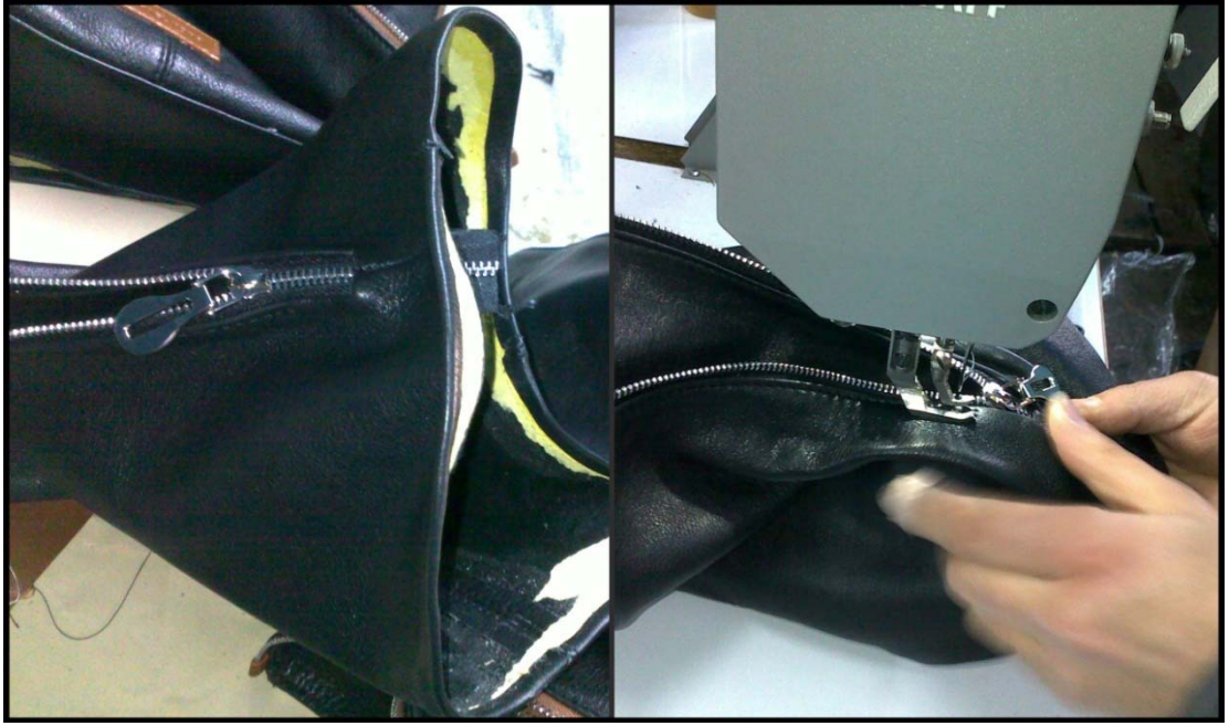
Fotoğraf 35 : Yan Sufle Fermuar Kafalarının Takılması ve Dikilmesi
