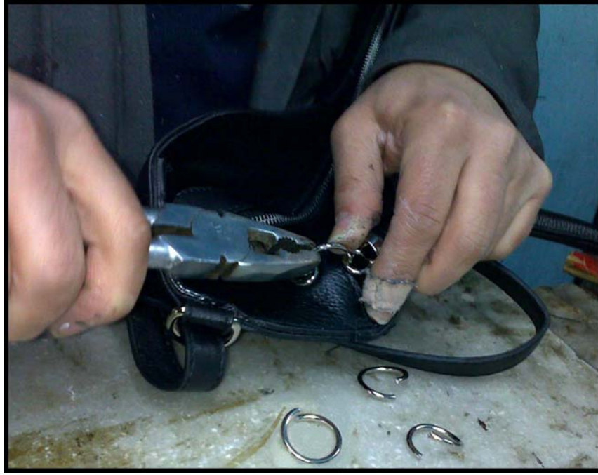
Fotoğraf 50: Fitol Sapların İ Sufleye Monte Edilmesi
