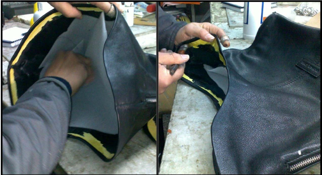
Fotoğraf 36: Çanta Gövdelerinin Süngerle Sertleştirilmesi
