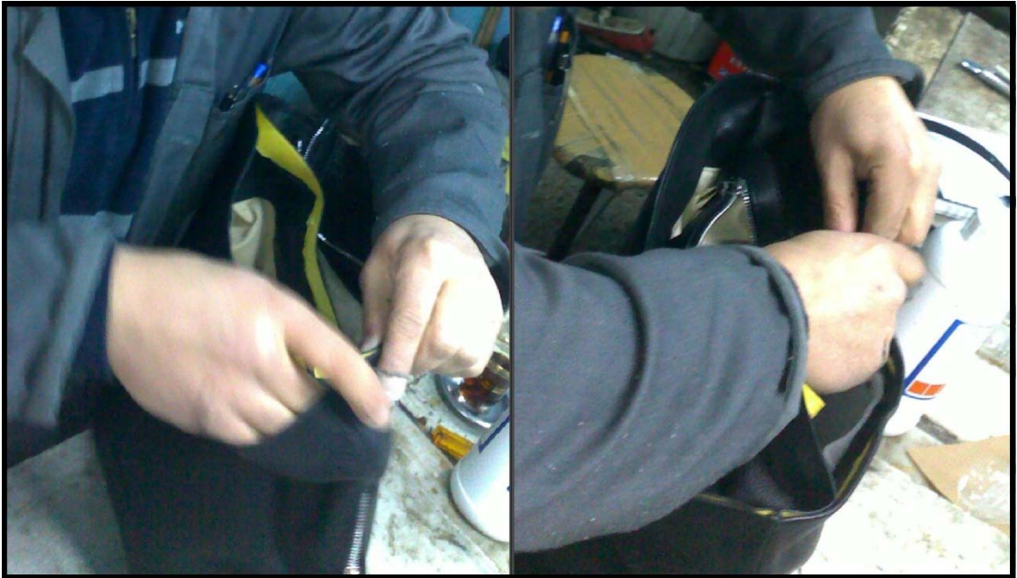
Fotoğraf 43: Deri Gövde ile Astar Gövdenin Birbirine Yapıştırılması
