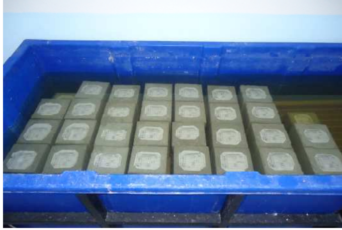
Şekil 4.13. Küp beton modellerinin kürü için havuza yerleştirilmesi.
