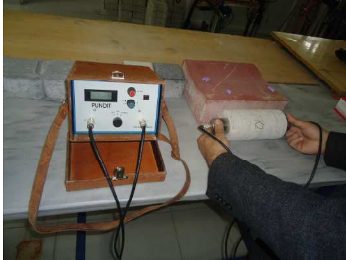
Şekil 4.31. Karotların ultrases geçiş hızlarının belirlenmesi.
