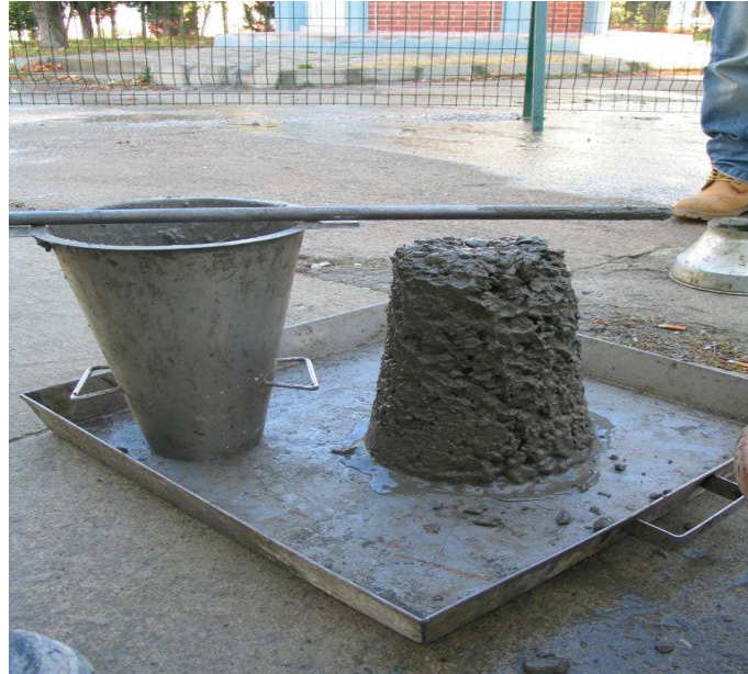
Şekil 4.10. Hazırlanan taze betonun çökme değerine bakılması (slump).
