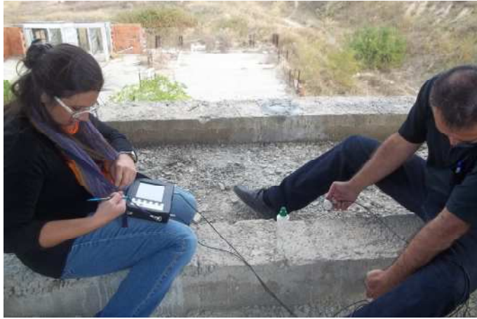
Şekil 4.25. Kiriş üzerinde ultrases geçiş süresinin ölçülmesi.
