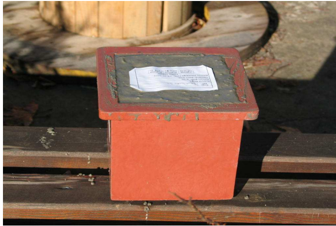
Şekil 4.12. Hazırlanan taze betonun plastik küp kalıplara dökülmesi.
