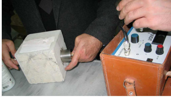
Şekil 4.18. Küp beton modeller üzerinde ultrases geçiş hızının ölçülmesi.
