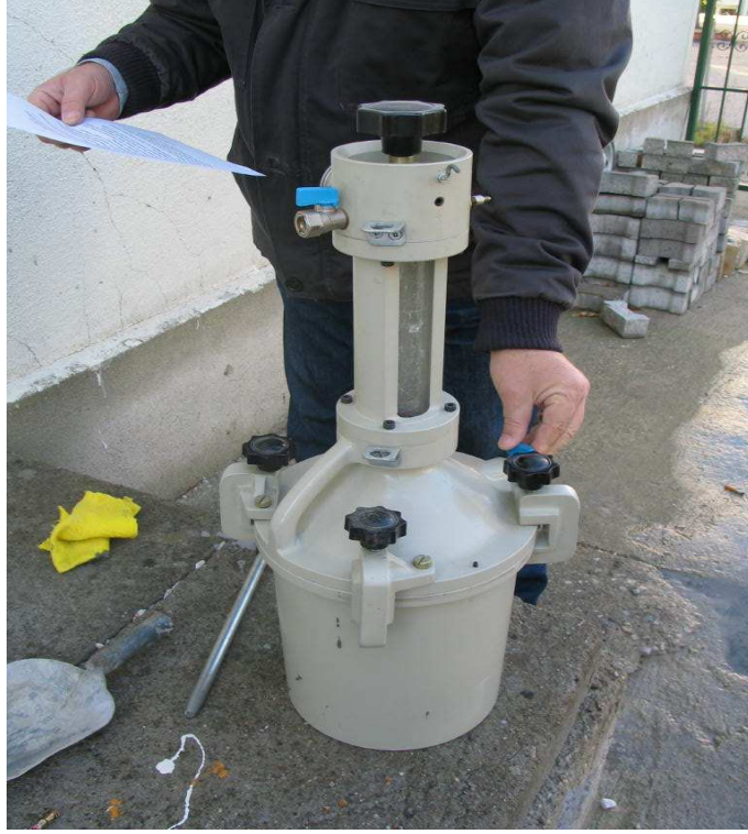
Şekil 4.11. Taze betondaki hava miktarının belirlenmesi.
