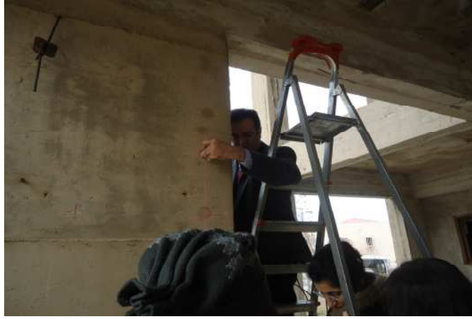
Şekil 4.24. Kolonlar üzerinde ultrases geçiş süresinin ölçülmesi.
