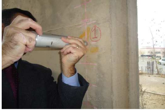
Şekil 4.26. Belirlenen elemanlar üzerinde Schmidt çekici ile yüzey sertlik değerlerinin okunması.
