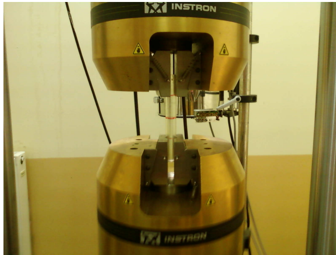
Şekil 4.6: Basit çekme için numunenin bağlanması
