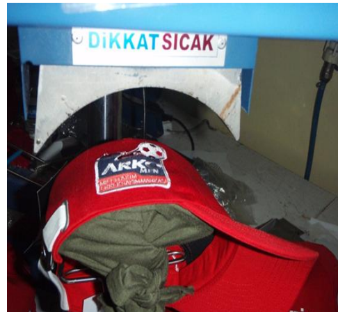
Şekil.15 - Tela Yapıştırma Presi. (Şapka için)
