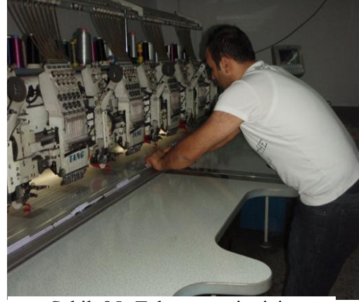
Şekil. 85- Telanın üretim için makineye gerilmesi.
