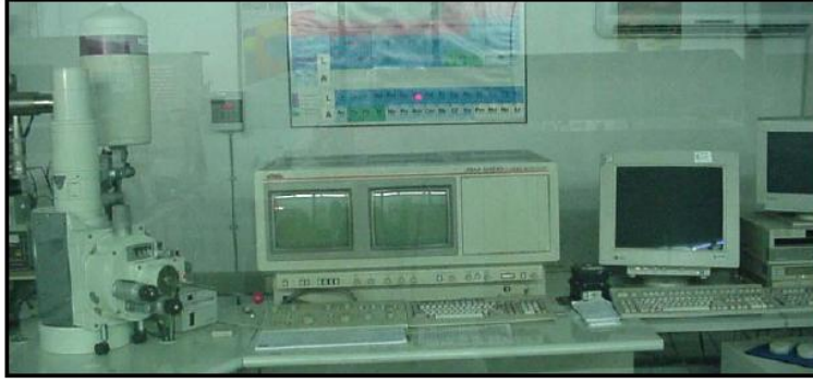
Şekil 3.9 : Taramalı elektron mikroskobu.
