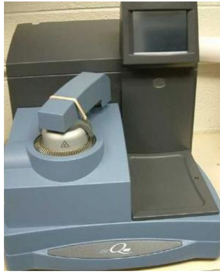
Şekil 3.10 : Diferansiyel taramalı kalorimetre.
