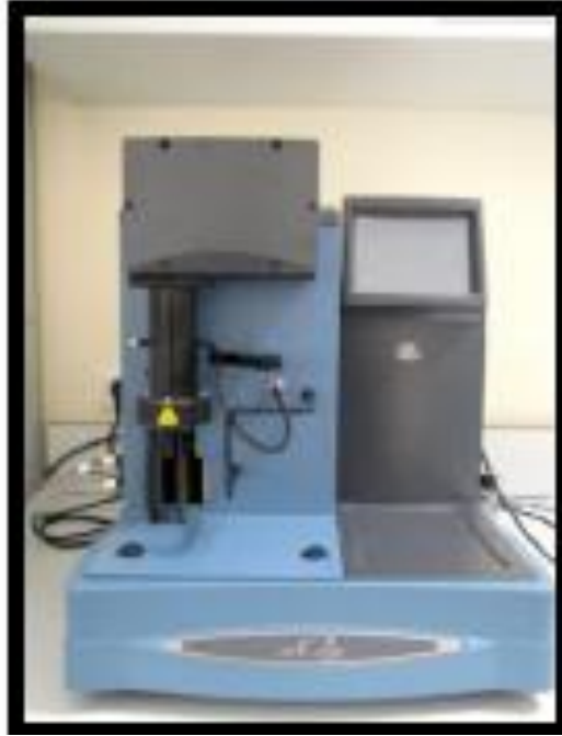
Şekil 3.11 : Termal gravimetrik analiz cihazı.
