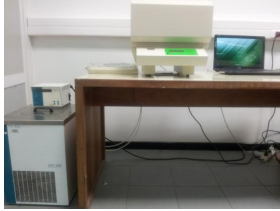
Şekil 3.6 : Isı iletim katsayısı ölçüm cihazı
