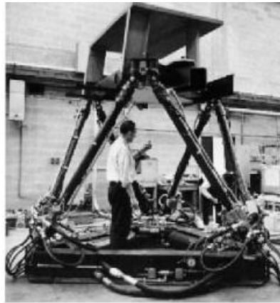
Şekil 2.4 : Klaus Cappel tarafından tasarlanan uçuş simülatörü [15].
