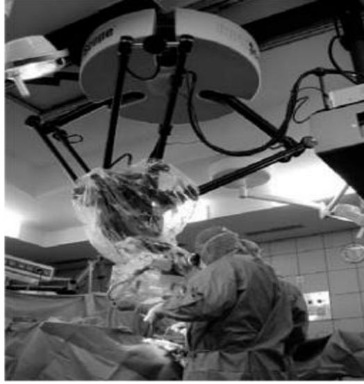
Şekil 2.14 : Ameliyatlarda mikroskopun hassas kontrolü için SPM kullanımı [15].
