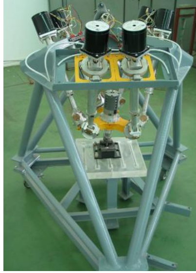
Şekil 2.7 : Paralel ve seri mekanizmalardan oluşan bir hibrit mekanizma [16].
