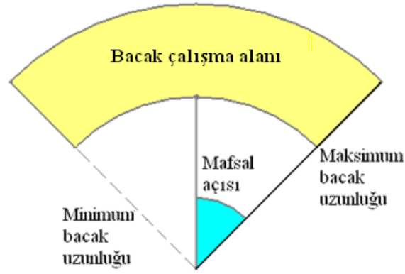
Şekil 4.2 : Kısıtlar dahilinde tek bacağın çalışma alanı.
