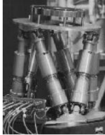
Şekil 2.17 : Değişken uzunluklu bacaklara sahip SPM [15].
