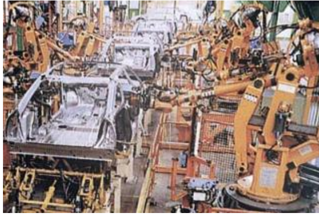
Şekil 2.5 : Otomobil üretim bandında kullanılan seri mekanizma [14]
