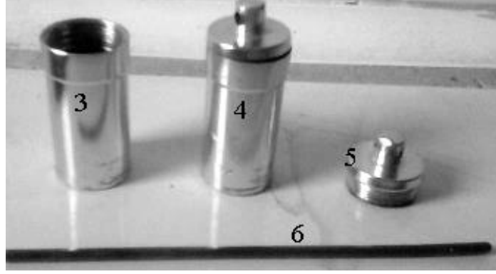
Şekil 5.2. Piroliz deney sistemi (3, reaktör gövdesi; 4, kapatılmış reaktör; 5, reaktör kapağı; 6, metal kapatma çubuğu)
