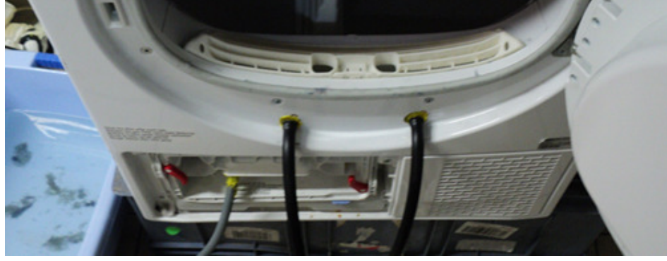
Şekil 5.10 : Makinanın hortum bağlantıları yapılmış görünüşü.
