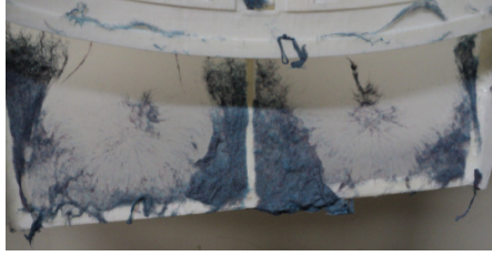
Şekil 5.14 : 8 çevrim sonundaki temizlenmiş filtre.
