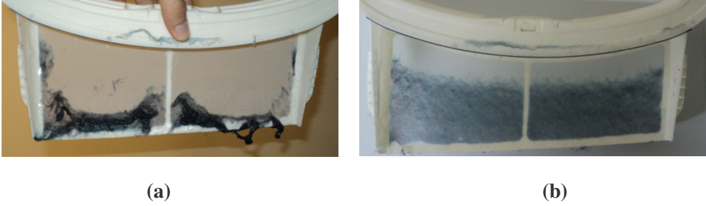
řekil 5.12 : (a) Temizlenmiř filtre (b) Temizlenmemiř filtre.
