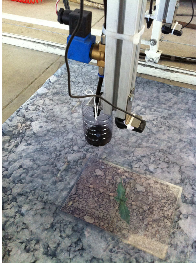
Şekil 3.89. Yabancı otlar üzerine uygulanan ilaçlama sıvısı ölçüm düzeneği
