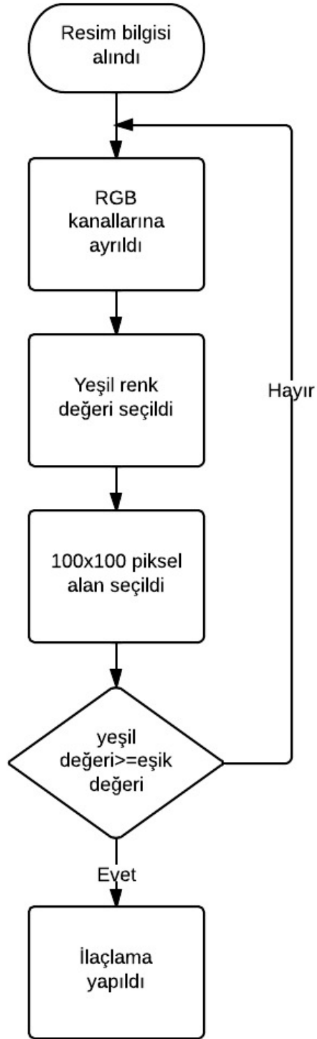
Şekil 3.41. Sıra arası yabancı ot ilaçlamasına ait akış diyagramı
