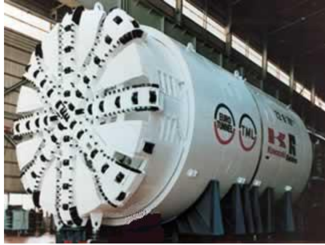
Şekil 1.4. Tam kesitte tünel açma aygıtından bir görünüm
