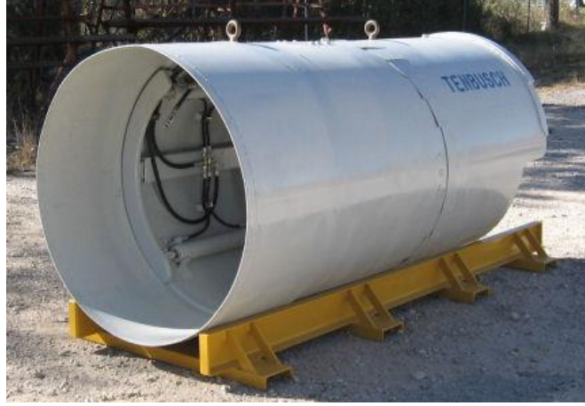
Şekil 1.6. Yumuşak zeminlerde tünel inşasında kullanılan kalkandan bir görünüm (URL-1, 2012).
