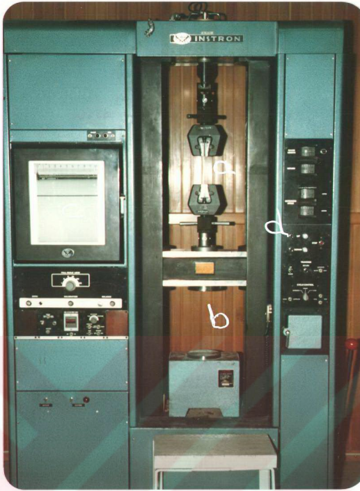
Şekil 9: Bu çalışmada kullanılan test cihazı, "Floor Model Instron TT. CM. Model", cihazın orta bölümünün üst tarafı (a) çekme koparma (Kemik-Ligamenet-Kemik preparatı monte edilmiş durumda), alt tarafı (b) ise sıkıştırma-ezme, deneyleri içindir. Sağ tarafı (c) kayıt (ossilograf) ve skala ayar düğmeleri, sol tarafta (d) ise yükleme oranı, uzama miktarları kumanda ve gösterge üniteleri bulunmaktadır. (Türk Standartları Enstitüsü-Ankara).
