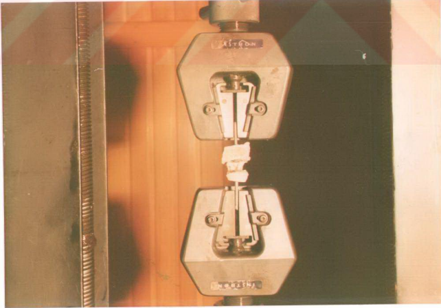
Şekil 8: Floor Model Instron TT.CM.Model cihazın tutucu çeneler arasında, test uygulanmak üzere monte edilmiş Kemik-Ligament-Kemik preparatı görülmektedir (Ölçek 1/4).
