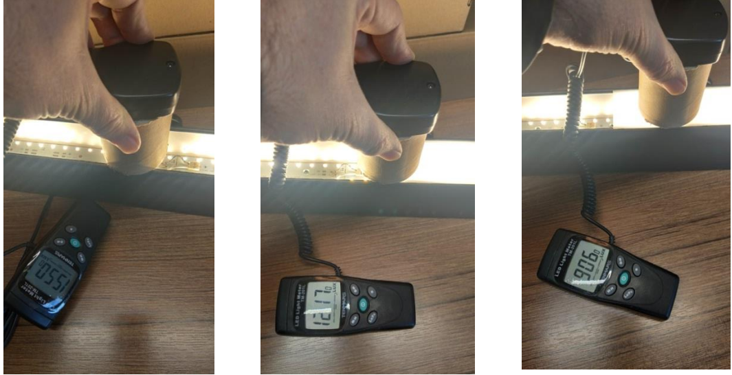
Şekil 8.22: Lüksmetre ile ölçüm
