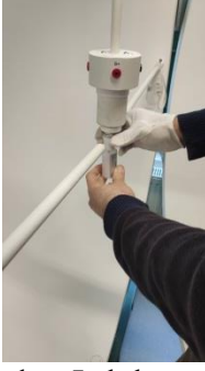
4. Standart Işık kaynağının ölçüm noktasına bağlanması
