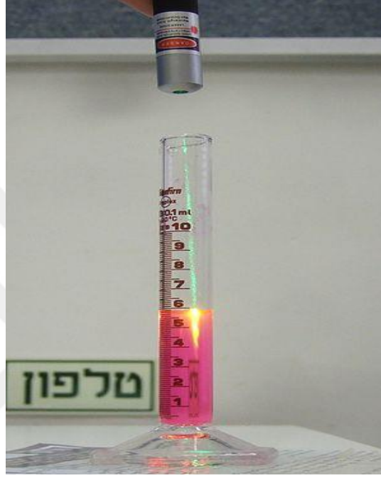
Şekil 4.4: Beer-Lambert yasasının bir örneği. Rhodamine 6B çözeltisini aydınlatan bir yeşil lazerin hüzmesi sıvının içinde ilerledikçe zayıflar.
