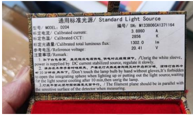
7. Standart ışık kaynağının kalibre edilmiş, standart değerleri
