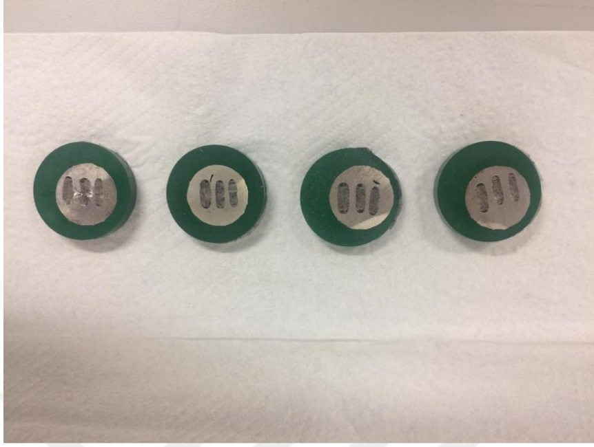
Şekil 5.8. Aşınma deneyi sonrası numunelerin görüntüleri.
