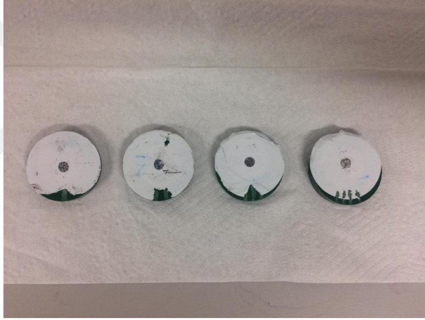
Şekil 5.11. Korozyon sonrası numune görüntüleri.
