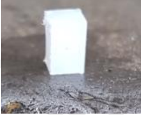
Şekil 4.6. Standartlara göre hazırlanmış basma numunesi
