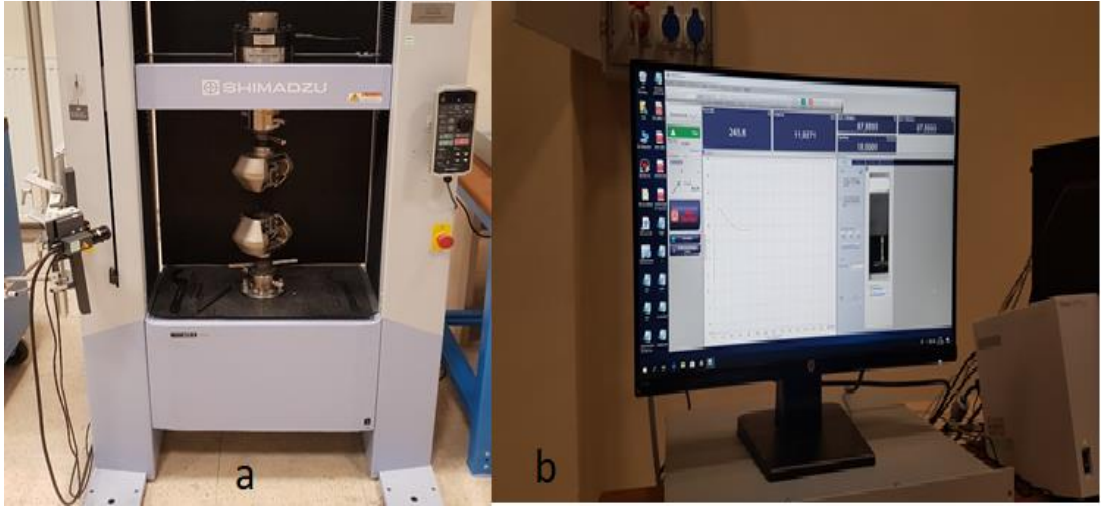
Şekil 3.1. SHIMADZU üniversal test cihazı (a) ve sonuçların alındığı bilgisayar (b)
