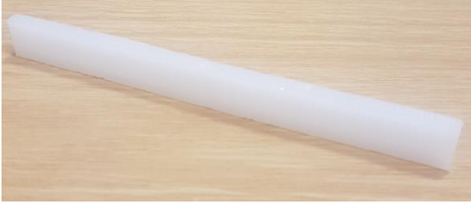
Şekil 4.8. Standart olarak hazırlanmış 3 nokta eğme numunesi
