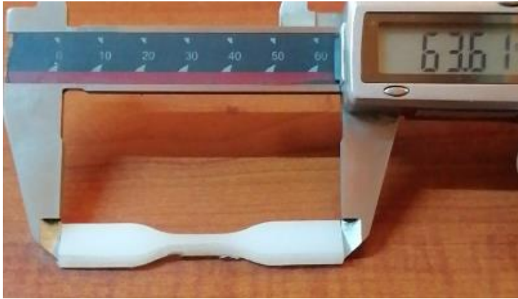
Şekil 4.3. Deneilerde kullanılacak standart çekme numuneleri
