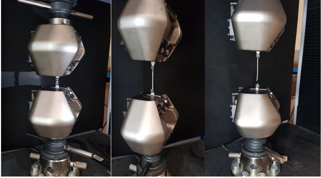
Şekil 4.4 Çekme deneyi sırasında UHMWPE numunenin deforme olması
