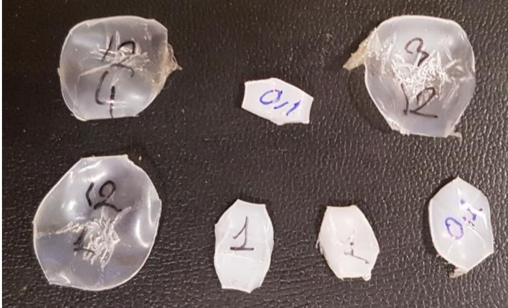
Şekil 6.8. Basma deneyi sonucunda deforme olmuş numuneler
