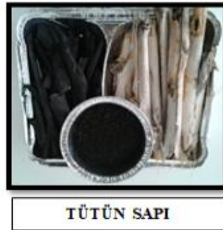
Şekil 3. 3. Zeytin Posası ve Tütün Sapı Biyokömürünün Ana Materyal ve Biyokömür Halleri
