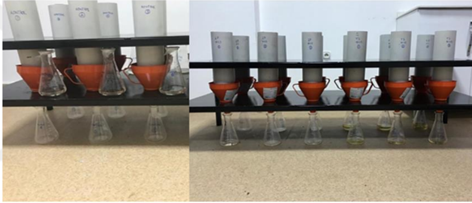
Şekil 3. 1. Laboratuvar Alanında Kolon Düzenegi
