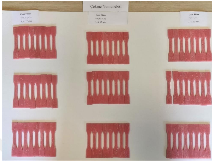
Şekil 3. 18. Hacimce %0,25, %0,5, %1 ve 3, 6, 12 mm boyutlarında cam fiber takviyeli çekme testi numuneleri (Yukarıdan aşağıya 3 mm, 6 mm, 12 mm, soldan sağa %0,25, %0,5, %1 şeklinde sıralanmıştır.)
