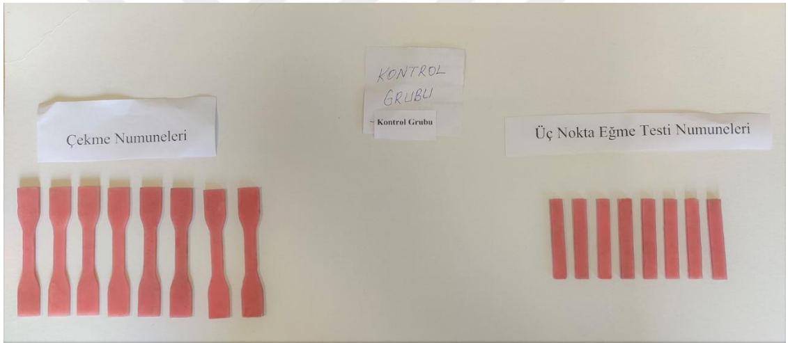
Şekil 3. 9. Kontrol grubu çekme ve üç nokta eğme test numuneleri
