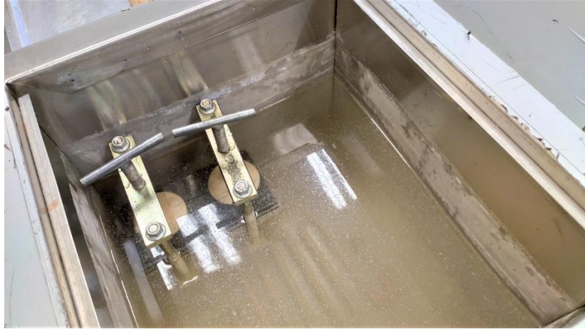
Şekil 3. 8. Kalıbın polimerizasyon kazanına konumlandırılması
