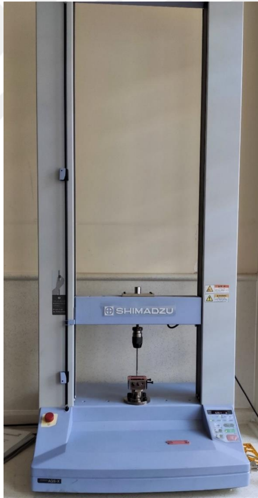
Şekil 3. 23. Çekme ve üç nokta eğme testlerinin gerçekleştirildiği universal test cihazı
