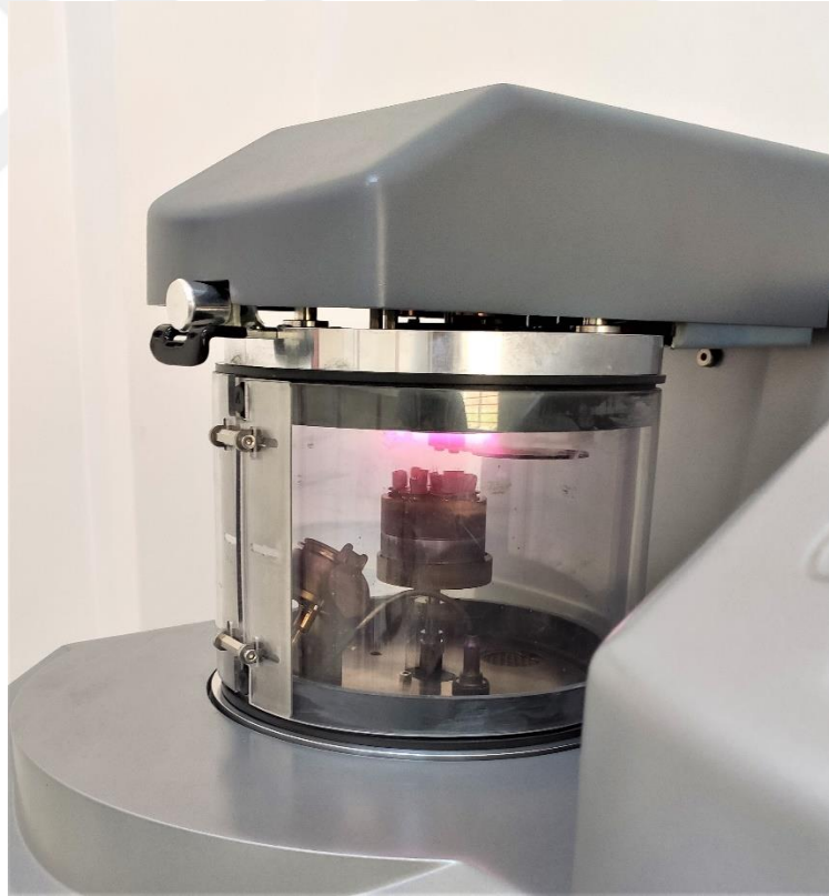
Şekil 3. 26. Vakum altında kaplama işlemi
