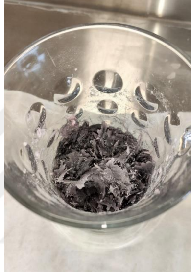
Şekil 3. 20. Hacimce %0,5 karbon fiber – PMMA karışımı ile oluşturulmuş takviyeli grubun görüntüsü
