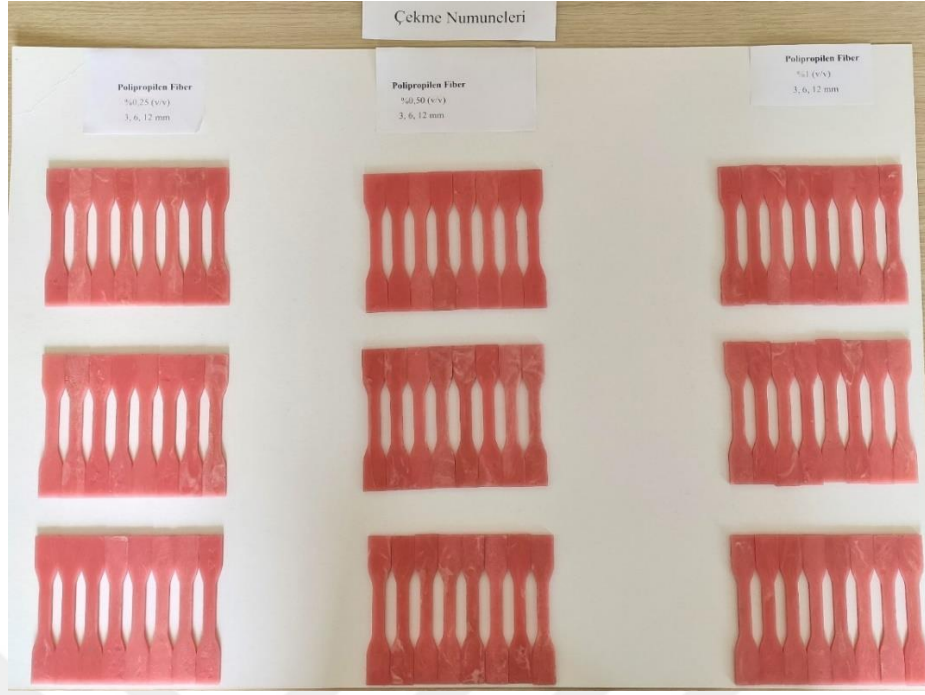
Şekil 3. 13. Hacimce %0,25, %0,5, %1 ve 3, 6, 12 mm boyutlarında polipropilen fiber takviyeli çekme testi numuneleri (Yukarıdan aşağıya 3 mm, 6 mm, 12 mm, soldan sağa %0,25, %0,5, %1 şeklinde sıralanmıştır.)
