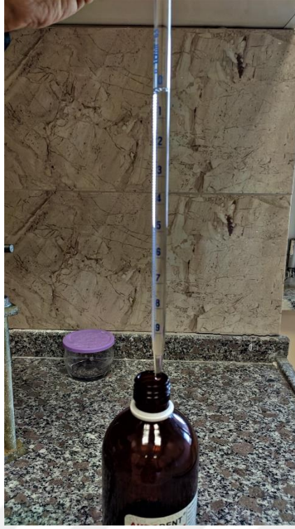
Şekil 3. 3. Likitin cam pipet ile şişeden alınması
