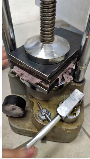
Şekil 3. 5. Kalıptaki fazla akrilik hamurun preslenerek dışarı alınması
