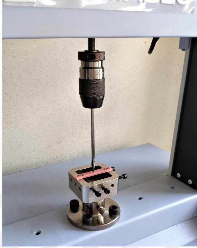
Şekil 3. 24. Üç nokta eğme testi uygulaması
