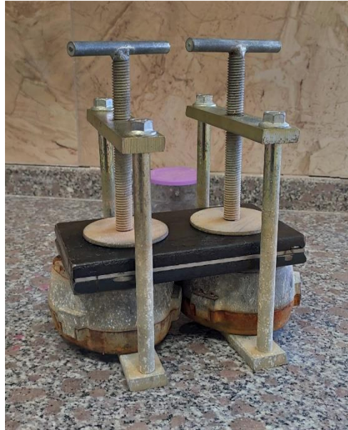
Şekil 3. 6. Brit ve muflalarla sabitlenmiş kalıp
