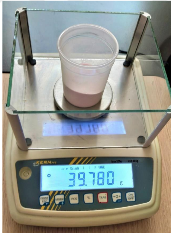
Şekil 3. 2. Hassas terazide tartımı yapılan standart oranın 1,7 katı miktarda toz PMMA
