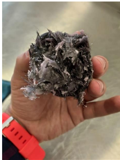
Şekil 3. 21. Hacimce %0,5 karbon fiber – PMMA karışımı ile oluşturulmuş takviyeli grubun görüntüsü
