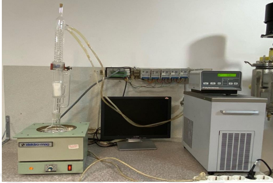
Şekil 4.6 Beta glukan üretiminde kullanılan Soxhlet ekstraksiyonun deney sistemi
