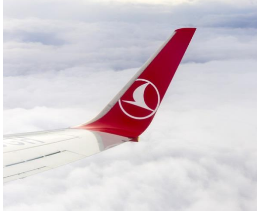
Şekil 3.3: Hava burgaçlarının küçültülmesine yönelik kanat tasarımı (mediacat.com).
