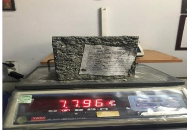
Şekil 5.23: 7 Günlük Çipli Beton Numunesi Kürleme İşlemine Tabi Tutulduktan Sonra Beton Basınç Dayanımını Öğrenmek İçin Kırım Testi İçin Tartılır
