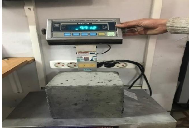
Şekil 5.32: 7 Günlük Çipli Beton Numunesi Kütleme İşlemine Tabi Tutulduktan Sonra Beton Basınç Dayanımını Öğrenmek İçin Kırım Testi İçin Tartılır
