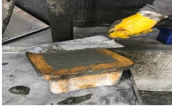
Şekil 4.3: Kalıptaki Çipsiz Taze Betonun Kalıp Yüzey Alanında Beton Dökülmesi Esnasında Taşan Fazla Numune, Mala İle Kesme Hareketi Yaparak Düzeltilmeli Ve Beton Yüzey Alanı Dikkatli Bir Şekilde Temizlenmeli
