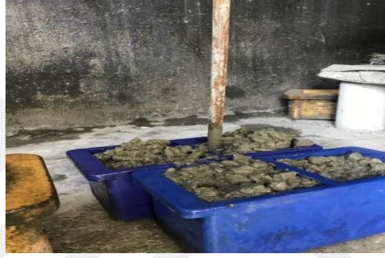
Şekil 4.1: Kalıplara Dökülen Çipsiz Taze Betonun Sıkıştırma Çubuğu Tarafından 25'er Defa Şişlenir Ve Her Tabaka İçin Aynı İşlem Tekrarlanır
