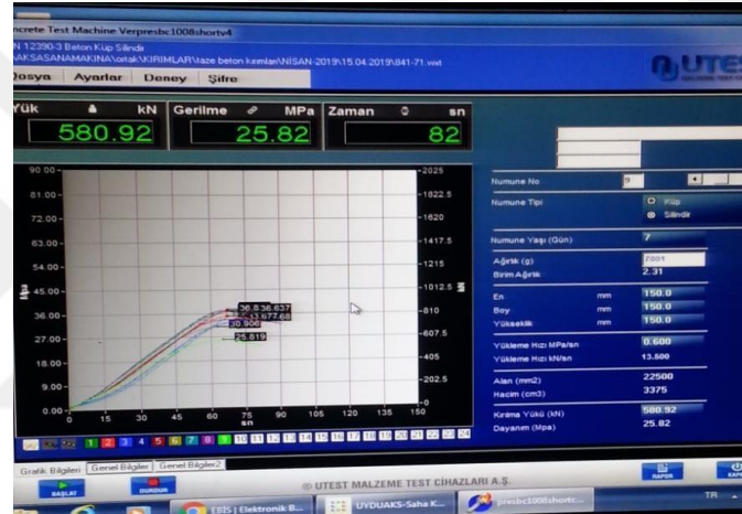
Şekil 4.11: Beton Basınç Deneyinde 7 Günlük Çipsiz Beton Numunesinin Basınç Dayanım Raporu
