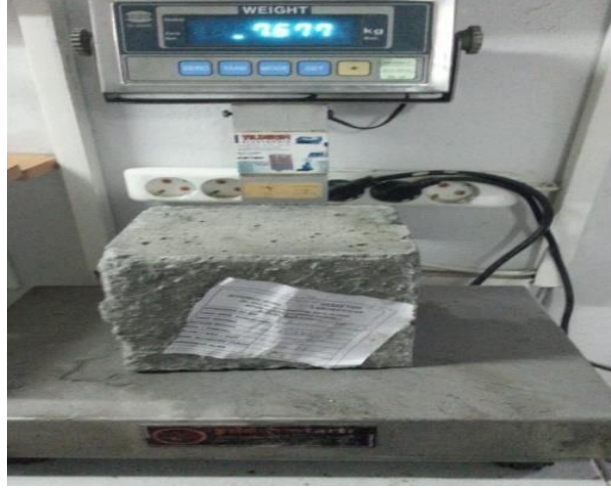
Şekil 4.12: 7 Günlük Çipsiz Beton Numunesi Kırılma İşlemine Tabi Tutulduktan Sonra Beton Basınç Dayanımını Öğrenmek İçin Kırım Testi İçin Tartılır
