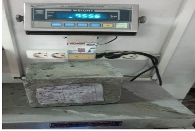
Şekil 4.20: 28 Günlük Çipsiz Beton Numunesi Kırılma İşlemine Tabi Tutulduktan Sonra Beton Basınç Dayanımını Öğrenmek İçin Kırılma Testi İçin Tartılır
