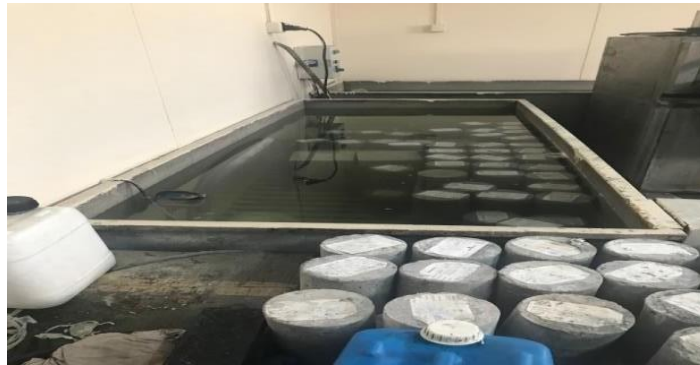
Şekil 4.4: Kür Havuzunda Bekletilen Çipsiz Beton Numuneleri
