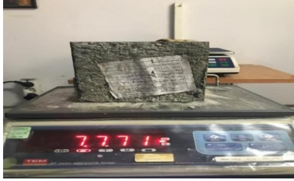
Şekil 5.28: 7 Günlük Çipli Beton Numunesi Kırılma İşlemine Tabi Tutulduktan Sonra Beton Basınç Dayanımını Öğrenmek için Kırım Testi İçin Tartılır
