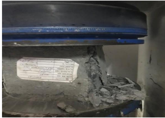
Şekil 4.9: Beton Basınç Deneyinde 7 Günlük Çipsiz Beton Numunelerinde Dayanım Testinden Sonra Görülen Küçük Hasarlar
