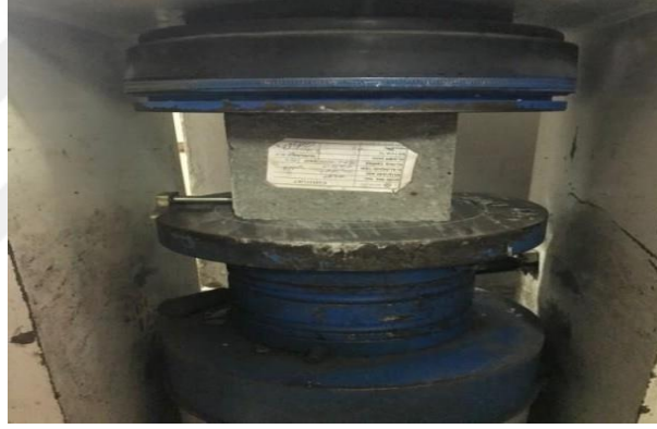
Şekil 4.8: Yük Uygulama Yönünün 7 Günlük Çipsiz Beton Döküm Doğrultusuna Dik Olması
