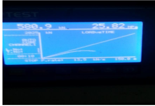
Şekil 4.10: Beton Basınç Deneyinde 7 Günlük Çipsiz Beton Numunesinin Dayanım Testinde Göstermiş Olduğu Basınç Dayanımı
