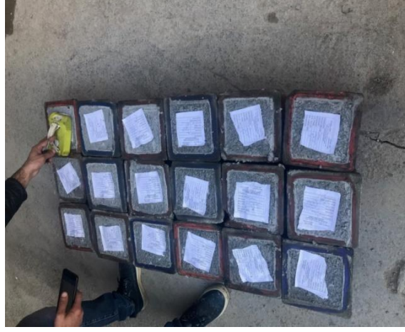
Şekil 5.11: El Terminali İle Okuma İşlemi Tamamlanan Numunenin Sahadan Çıkışı Yapılır
