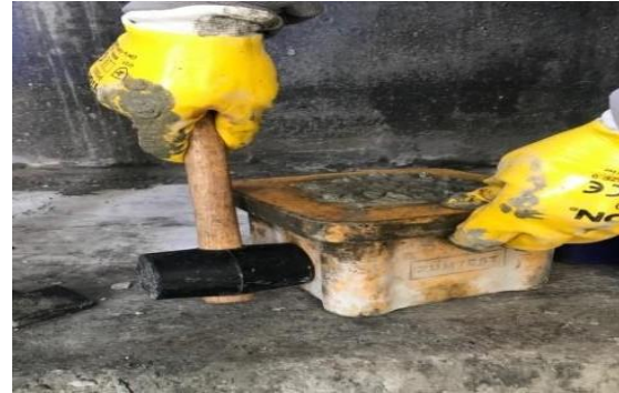
Şekil 4.2: Kalıptaki Çipsiz Taze Betona Çubuk Etkisinden Oluşan Boşluklar Dolana Kadar Tokmak İle Hafif Bir Şekilde Vurulur
