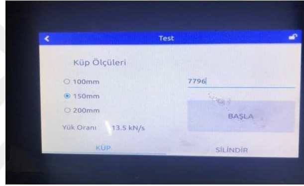
Şekil 5.24: 7 Günlük Çipli Beton Numunesi Hakkındaki Bilgiler; Numune Küp Ölçüleri Seçildikten Ve Ağırlık Girildikten Sonra Test Başlatılır
