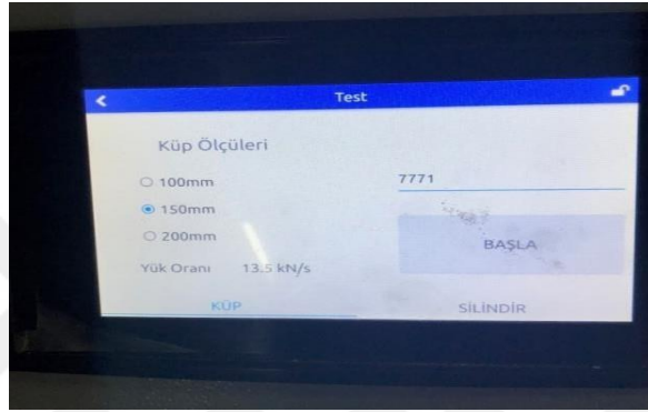
Şekil 5.29: 7 Günlük Çipli Beton Numunesi Hakkındaki Bilgiler; Numune Küp Ölçüleri Seçildikten Ve Ağırlık Girildikten Sonra Test Başlatılır
