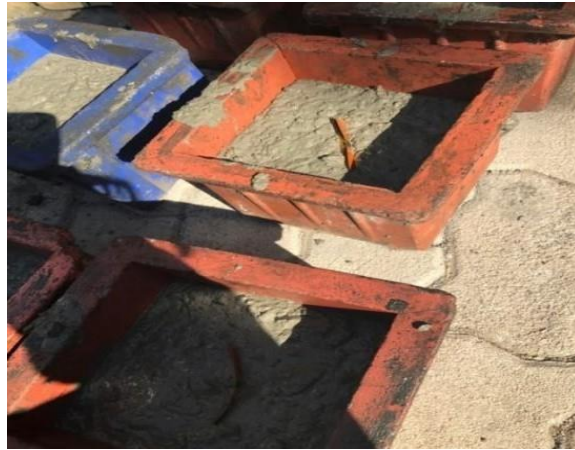
Şekil 5.19: Taze Beton Harmanı Şişleme İşleminin Sonra Rfid Etiket Zarar Vermeden Beton İçine Yerleştirilir
