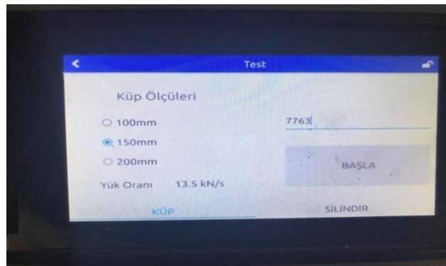
Şekil 5.41: 28 Günlük Çipli Beton Numunesi Hakkındaki Bilgiler; Numune Küp Ölçüleri Seçildikten Ve Ağırlık Girildikten Sonra Test Başlatılır
