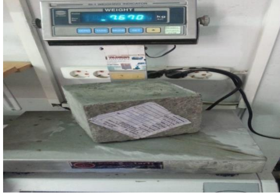
Şekil 4.17: 28 Günlük Çipsiz Beton Numunesi Kürleme İşlemine Tabi Tutulduktan Sonra Beton Basınç Dayanımını Öğrenmek İçin Kırım Testi İçin Tartılır
