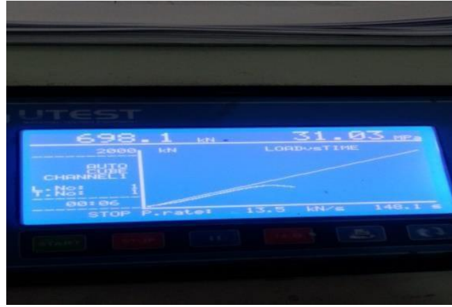
Şekil 4.18: Beton Basınç Deneyinde 28 Günlük Çipsiz Beton Numunesinin Dayanım Testinde Göstermiş Olduğu Basınç Dayanımı
