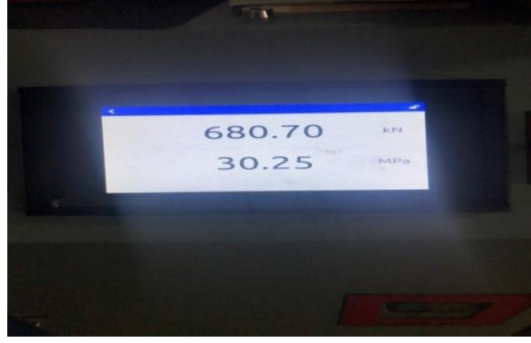
Şekil 5.26: Elektronik Kontrol Ünitesi Üzerinde Uygulanan Yük Değeri kN Ve MPa Olarak Gözlemlenir
