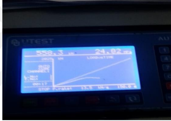
Şekil 4.13: Beton Basınç Deneyinde 7 Günlük Çipsiz Beton Numunesinin Dayanım Testinde Göstermiş Olduğu Basınç Dayanımı
