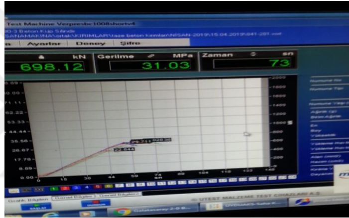
Şekil 4.19: Beton Basınç Deneyinde 28 Günlük Çipsiz Beton Numunesinin Basınç Dayanım Raporu
