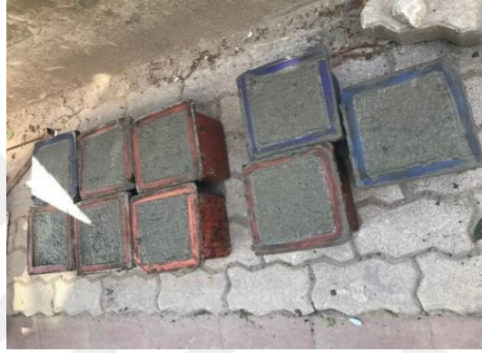
Şekil 5.21: Çipli Beton Numunesi Son İşlemden Sonra Mobil Uygulama Ve El Terminali Kullanımına Hazır Hale Getirilir
