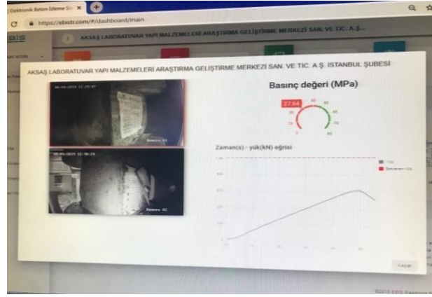
Şekil 5.33: 7 Günlük Çipli Beton Numunesi Yapılan Teste Dair Canlı Verilere, Ebis Merkezi İzleme Yazılımı Üzerinden Anlık Olarak Erişilebilir Ve Test Raporları Otomatik Olarak Oluşturulur
