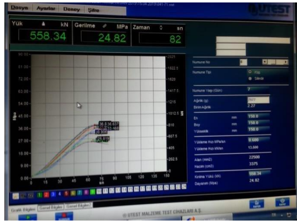
Şekil 4.14: Beton Basınç Deneyinde 7 Günlük Çipsiz Beton Numunesinin Basınç Dayanım Raporu
