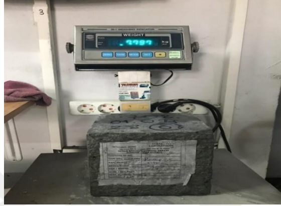
Şekil 5.37: 28 Günlük Çipli Beton Numunesi Kırılma İşlemine Tabi Tutulduktan Sonra Beton Basınç Dayanımını Öğrenmek İçin Kırım Testi İçin Tartılır
