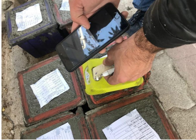
Şekil 5.10: El Terminali Yardımıyla Okuma İşlemi
