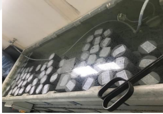
Şekil 5.12: Saha Ortamından Alınan Taze Beton Numuneleri Kür Havuzuna Konulur
