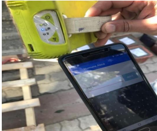
Şekil 5.22: Mobil Uygulama Üzerinden Veri Girişi Yapılır Ve El Terminali İle Hazırlanan Rfid Çipli Beton Numunesi Okutulur
