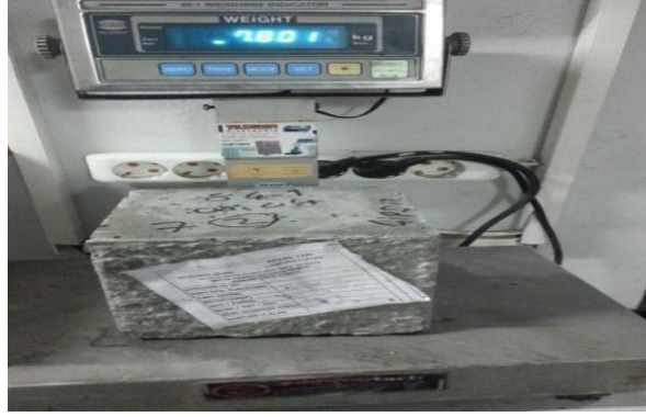
Şekil 4.7: 7 Günlük Çipsiz Beton Numunesi Kürleme İşlemine Tabi Tutulduktan Sonra Beton Basınç Dayanımını Öğrenmek İçin Kırım Testi İçin Tartılır
