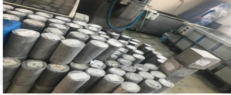
Şekil 4.5: Kür Ortamında Bekletilen Çipsiz Beton Numuneleri
