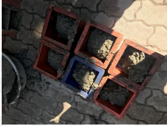
Şekil 5.18: Homojen Hale Getirilen Taze Beton Harmanı Numune Kalıbının Yarısına Kadar Beton İle Doldurulur Ve Doldurulan Numune Şişleme İşlemi Uygulanır
