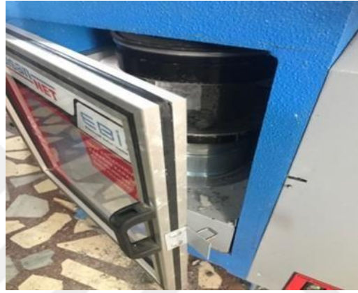
Şekil 5.27: Test Tamamlandığında, Kırım Test Haznesi Koruyucu Kapağı Otomatik Olarak Açılır
