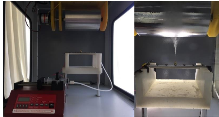
Şekil 3.5. Tez çalışması kapsamında kullanılan elektroğirme cihazını ve yapılan elektroğirme işlemini gösteren fotoğraflar.
