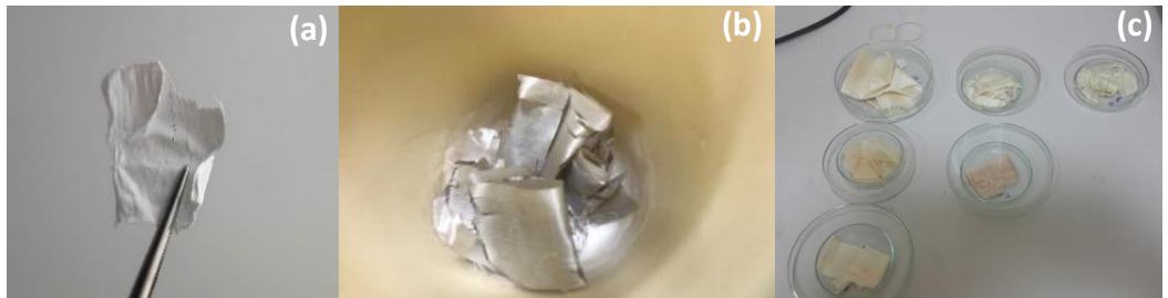
Şekil 4.5. Proje kapsamında sentezi yapılan biyoaktif cam nanoliflerin kalsinasyon sonrası görüntüleri (a), (b), (c).
