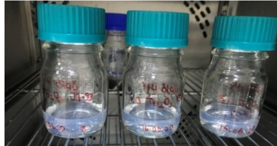
Şekil 3.2. 60 °C’de yaşlandırma işlemine tabi tutulan örneklerin görüntüleri.
