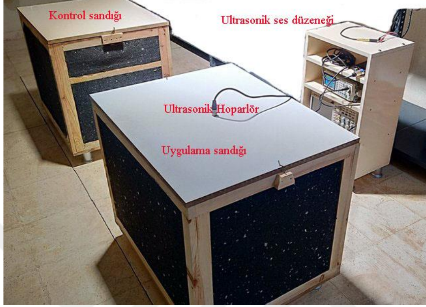
Şekil 3.15. Uygulama ve kontrol sandıkları ile ultrasonik ses dalgası düzeneği
