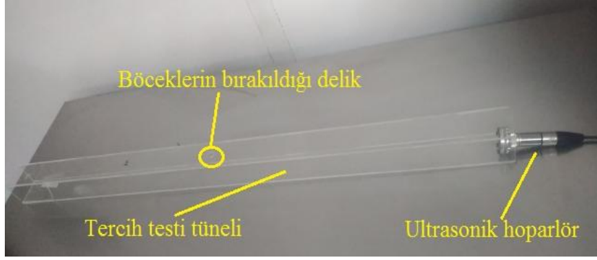
Şekil 3.26. Sitophilus granarius tercih testinde kullanılan ses düzeneği
