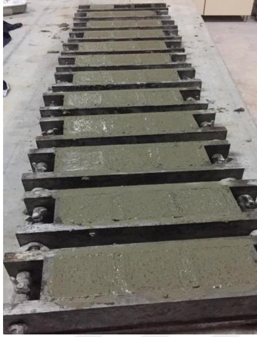
Şekil 20. 50×50×50 mm küp kalıplara dökülen numuneler.
