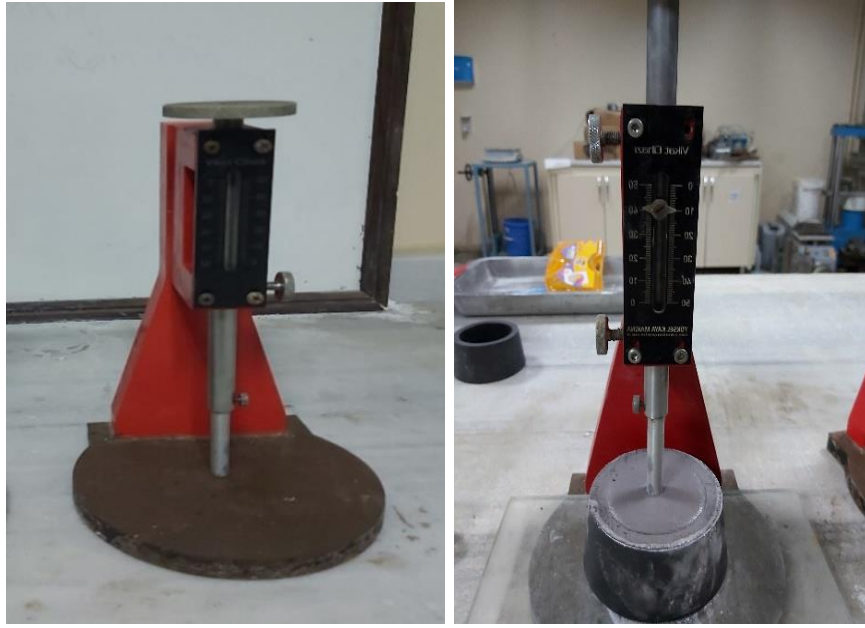
Şekil 25. Vicat aleti ve kıvam deneyi yapılan numune.
