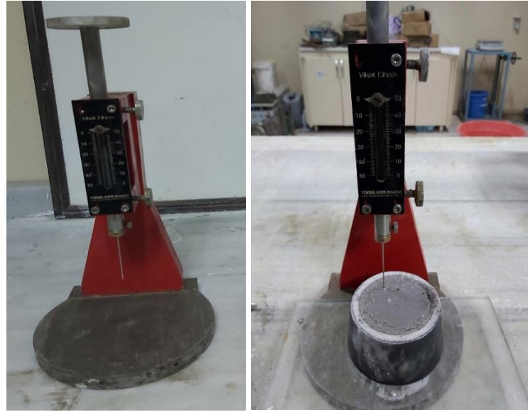
Şekil 26. Vicat aleti ve priz başlangıç ve bitiş deneyleri yapılan hamur.
