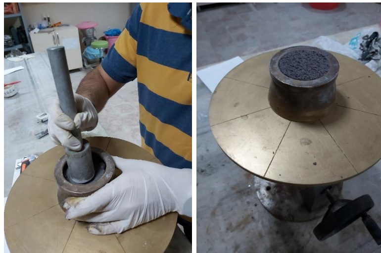
Şekil 27. Yayılma tablası ile kıvam tayini deneyi.
