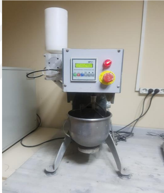
Şekil 21. İki aşamalı laboratuvar tipi mikser.
