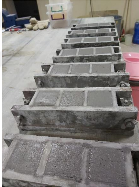
Şekil 19. 50×50×50 mm küp kalıplara dökülen alkali aktive numuneler.
