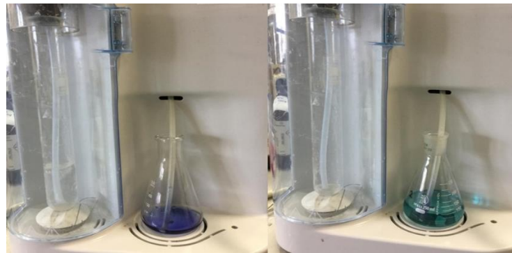
Şekil 3.4 Amonyak azotu distilasyon aşaması
