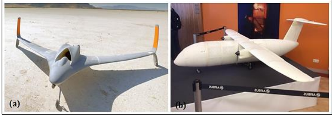
Şekil 1.26. EBY ile üretilen insansız hava araçları Aurora (a) ve Thor (b) (Stratasys, 2019; Airbus, 2016)
