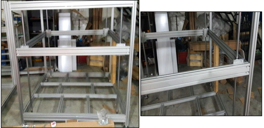
Şekil 3.3. Üç boyutlu yazıcının orta gövde montajı
