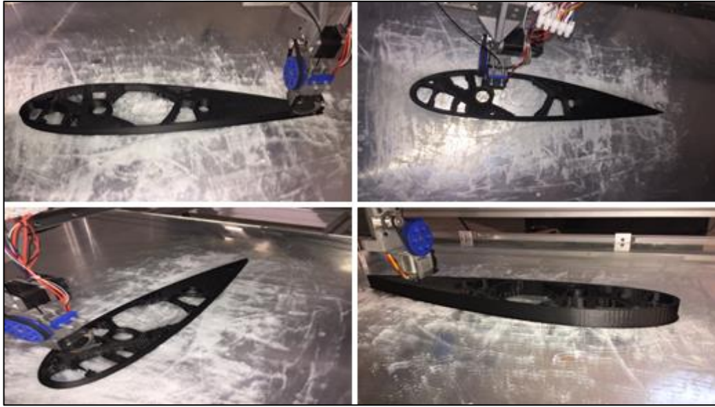
Şekil 4.43. Eriyik biriktirme yönteminde termoplastik matrisli karbon fiber takviyeli kompozit kanat profili üretimi
