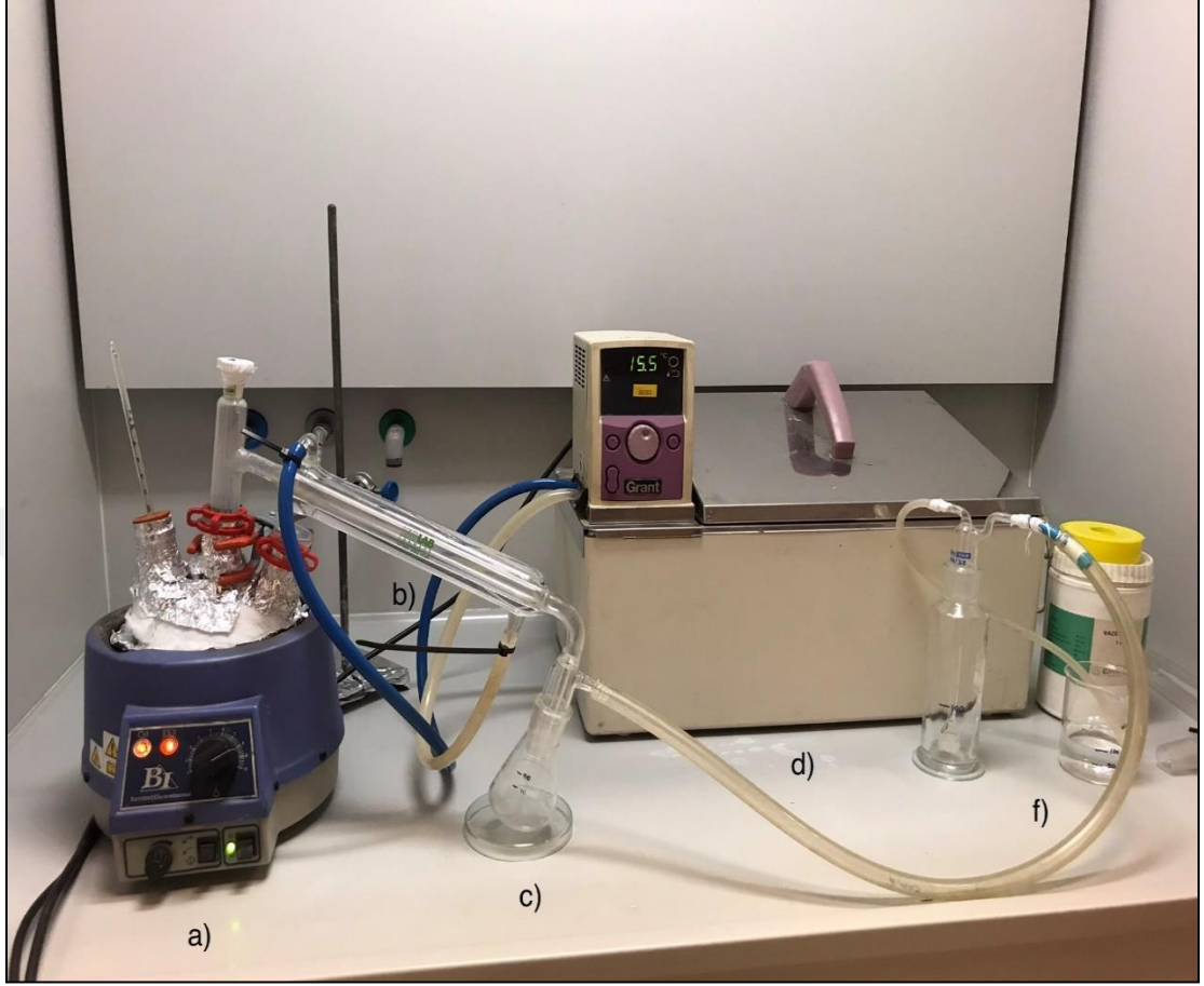
Şekil 4.1: Deneş Düzenegİ a) Kristalizasyon, b)Soğutma düzenegİ, c) Distilat, d) Soğutma cihazı , f) Yıkama şişesi bağlantısı.
