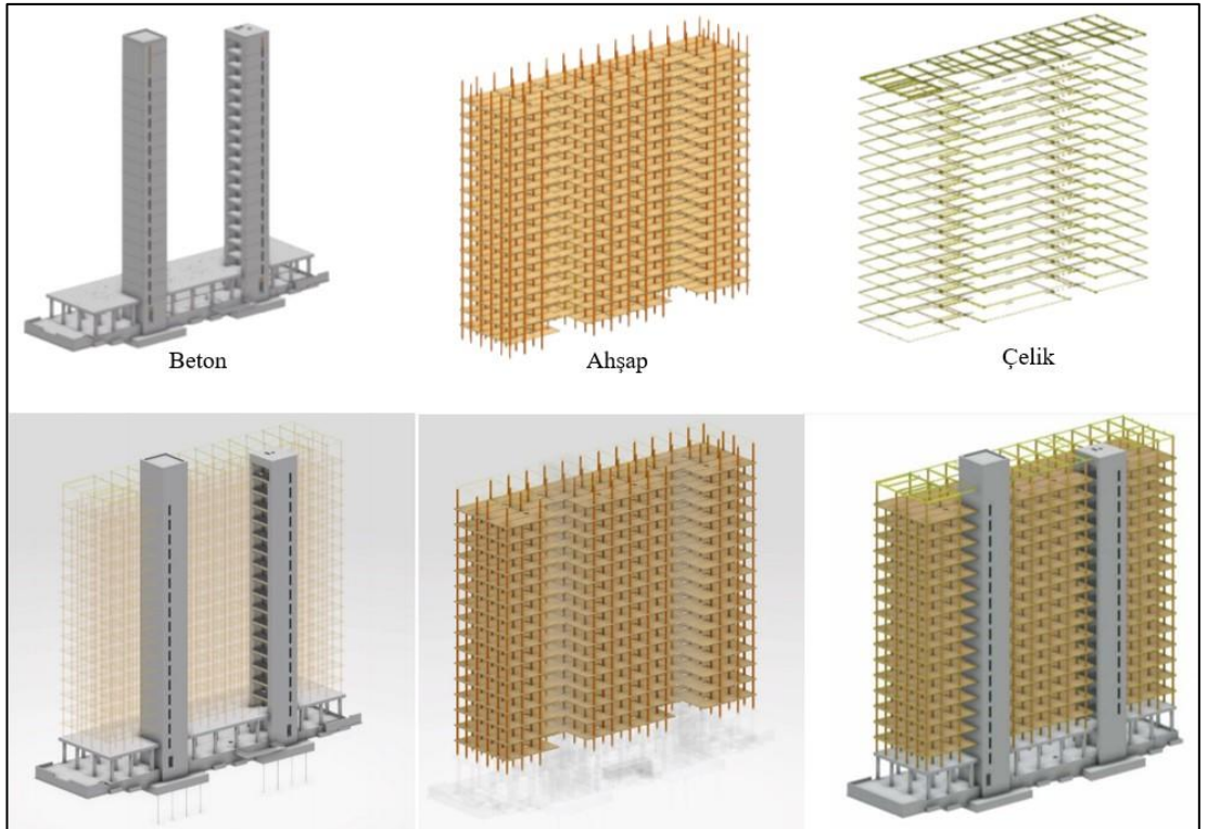
Şekil 4-12: Brock Commons Yapısı Taşıyıcı Sistemi (Fallahi,2017), (Fast, 2016).
