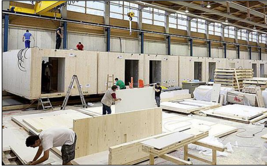
Resim 2-5: Ahşap Hacimsel Modüllerin Fabrika İmalatı (Wölfl, 2016).
