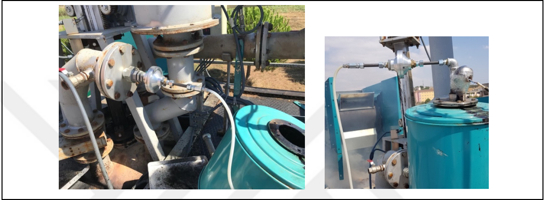
Şekil 4.8: Kirli gaz ve bütünleşik filtre sistemi çıkışlarındaki gaz alma hatları.
