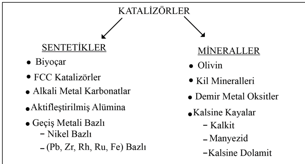
Şekil 3.9: Katran gideriminde kullanılan katalizörlerin sınıflandırılması.
