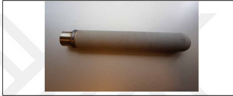
Şekil 4.4: Paslanmaz sinterlenmiş çelik filtre.
