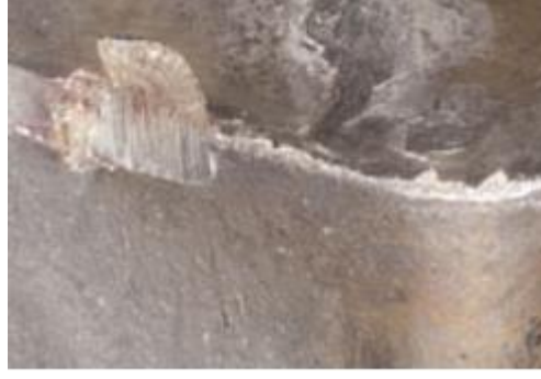
Şekil 2.22. Talaş yığılması (Anonim 1990b)
