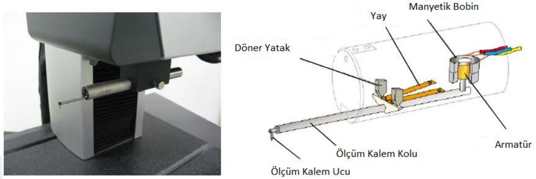
Şekil 2.17. Yüzey pürüzlülük cihazı ve iç yapısı
