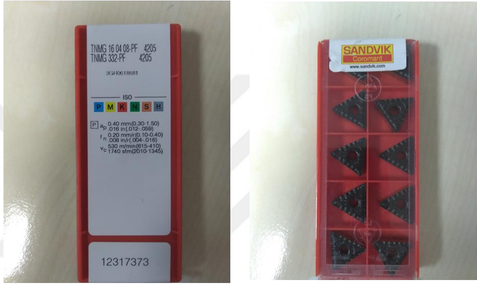
Şekil 3.8. TNMG 16 04 08-PF 4205 karbür kesici uç
