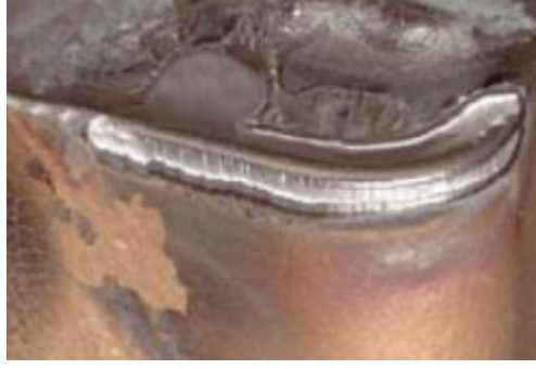
Şekil 2.20. Serbest yüzey aşınması (Anonim 1990b)
