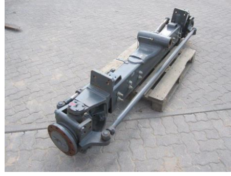
Şekil 2.14. SSF malzeme ile dökülmüş biçerdöver makinesinde kullanılan arka aksı
