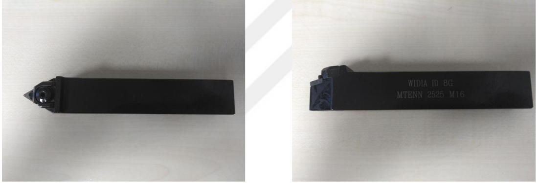
Şekil 3.13. MTENN 2525 M16 kodlu 60° yanaşma açılı takım tutucu
