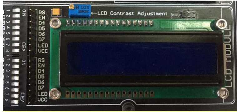
Şekil 5.22: Eğitim seti üzerinde yer alan LCD modül.
