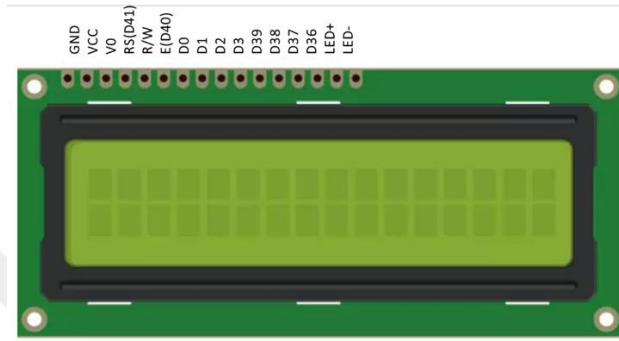
Şekil 5.20: 2x16 karakter LCD ve pinleri.
