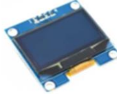
Şekil 3. 128x64 0.96 inch OLED Display Ekran
