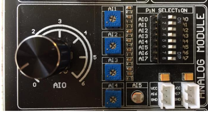
Şekil 5.17: Eğitim seti üzerindeki Analog modül ve analog modüle ait 8’li DIP-Switch.
