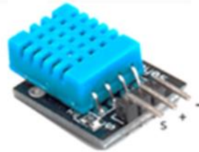
Şekil 3. DHT11 dijital sıcaklık ve nem sensörü
