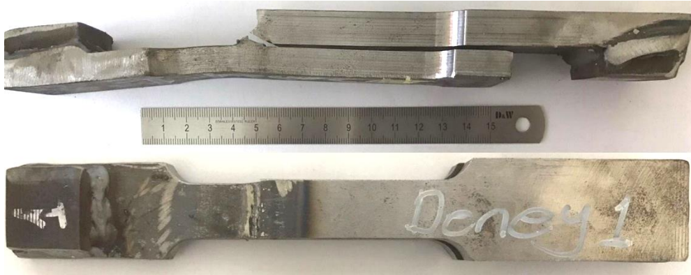
Şekil 5.4: Çekme-makaslama testi sonrası deney 1'e ait kopan numune görünümü.
