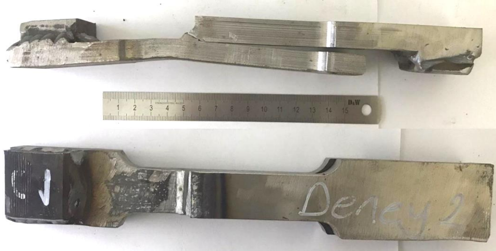
Şekil 5.5: Çekme-makaslama testi sonrası deney 2'ye ait kopan numune görünümü.
