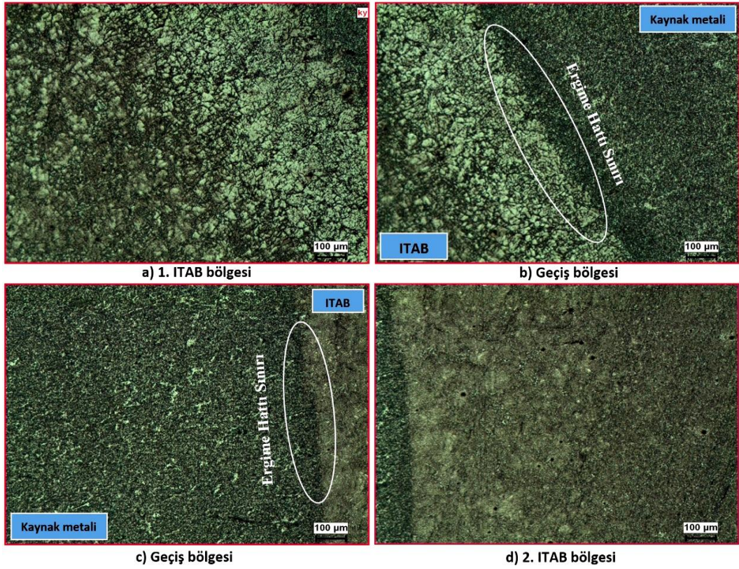
Şekil 5.18: 1.2mm masif tel ve %100CO 2 koruyucu gaz ortamında birleştirilen numunenin mikroyapı görüntüleri.
