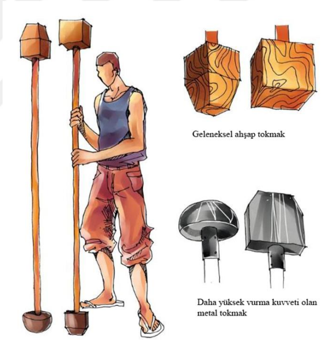
Şekil 2. 8: Geleneksel ahşap tokmak ve metalden imal edilen tokmak (URL 30).
