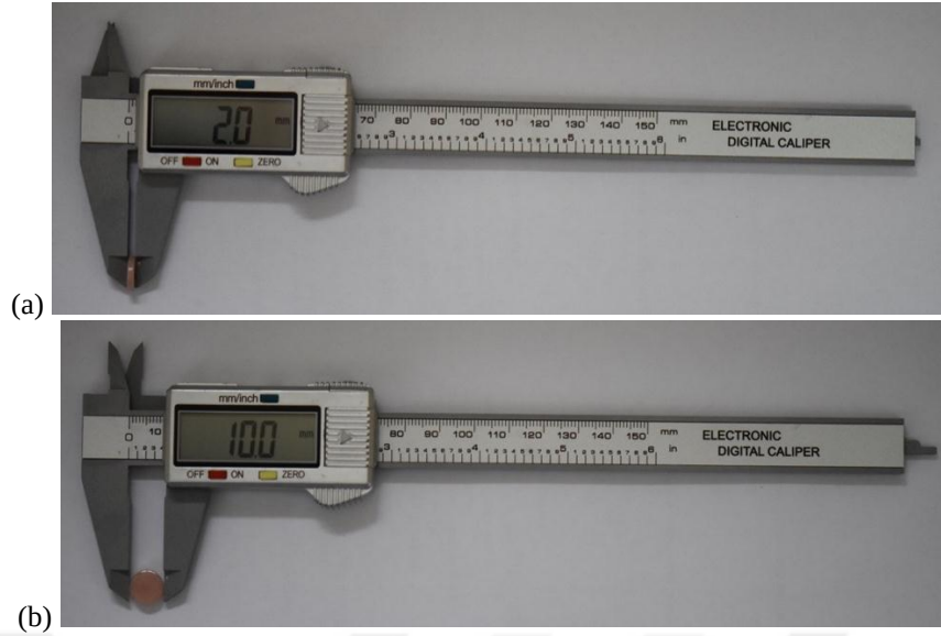
Şekil 3.4. Örneklerin kalınlık (a) ve çapının (b) ölçülmesi.
