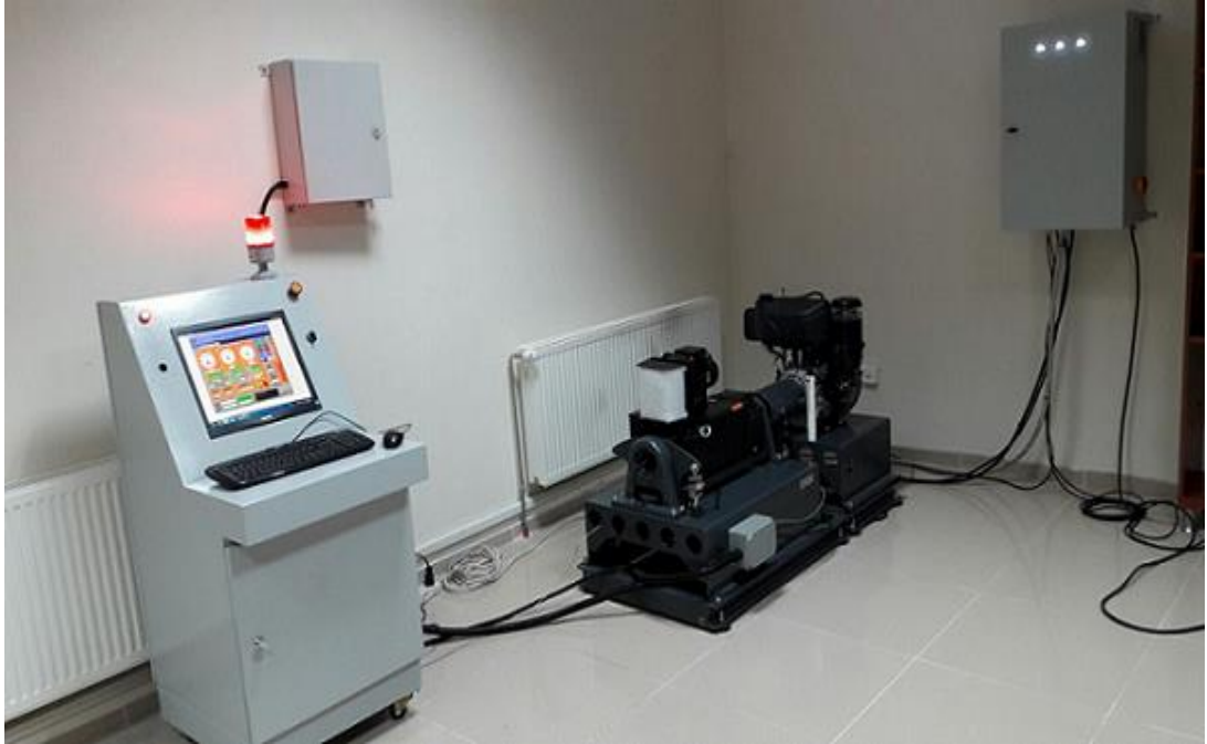
Şekil 4.2 NF marka motor dinamometresi
