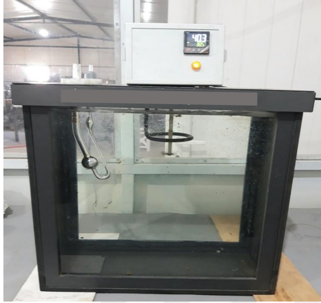
Şekil 4.7 Kinematik viskozite tayin cihazı
