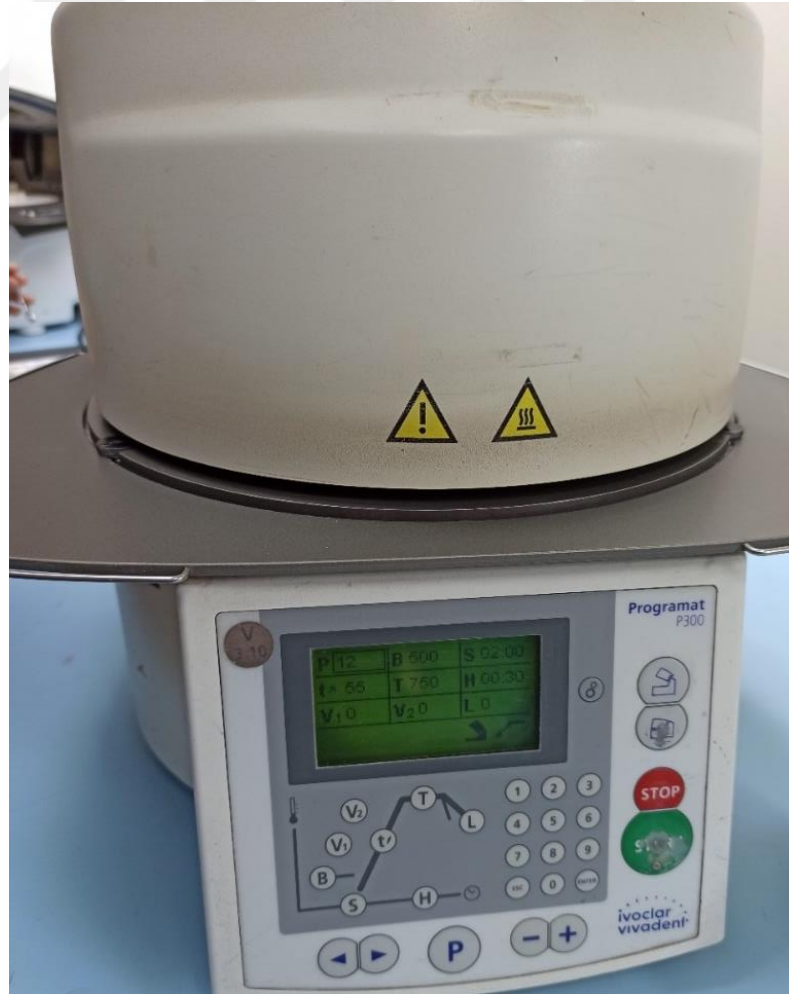
Resim 33: Restorasyonun Glazürünün Gerçekleştirildiği Seramik Fırını
