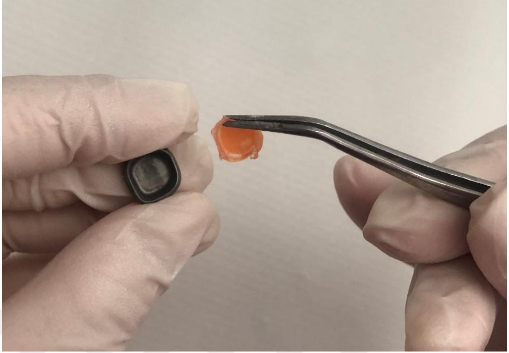
Resim 22: Alt Yapıların İç Uyumlarının Elastomerik Ölçü Maddesi Kullanılarak Kontrolü
