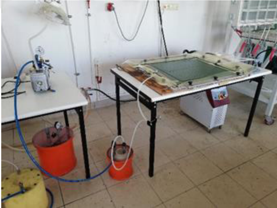
Şekil 3.11. Vakum infüzyon seti; kalıp sistemi, vakumpompası, kalıp ısıtıcı ve havalandırma sistemi
