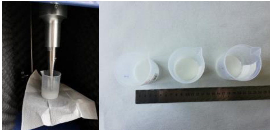
Şekil 3.25. Yapıştırıcının ultrasonik homojenizasyon cihazı ile karışımı
