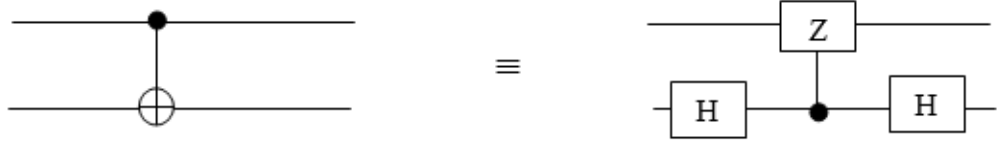
Şekil 2.15. Bir CNOT kapısı ile Hadamard-konjuge Z kapısının özdeşliği
