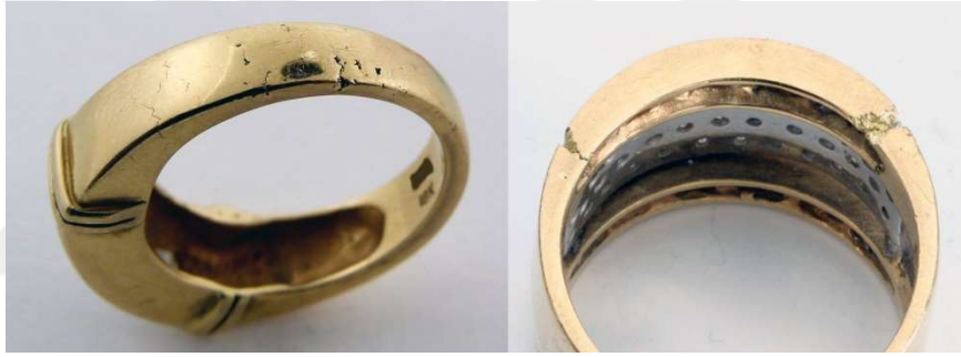
Şekil 48: Eksikli döküm ve porozite örnekleri
