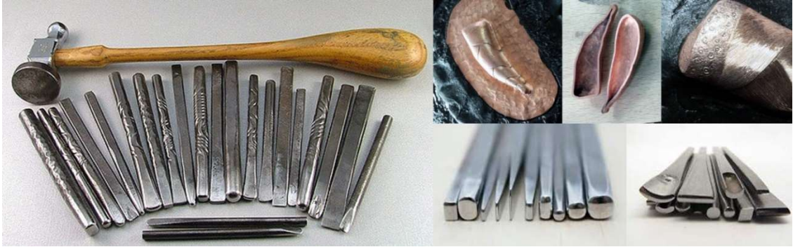
Şekil 26: Kabartma (çökertme) çalışma uçları ve etkileri
