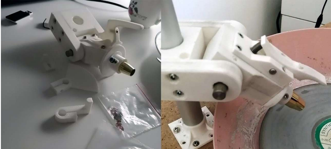
Şekil 56: 3B üretilmiş taş tıraşlayıcı
