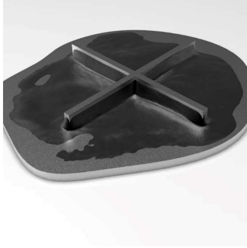
Şekil 68: Düşük ayar ile kaynaştırılmış parçalar
