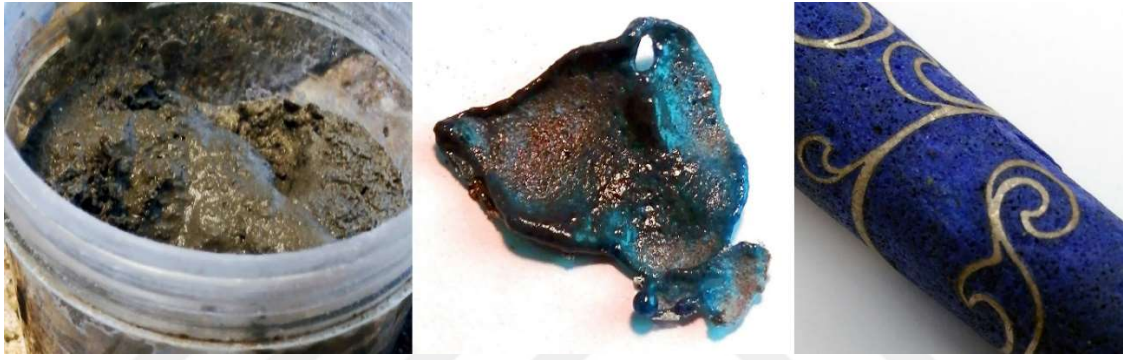
Şekil 78: Fayans karışımı, pişirim denemesi, uygulaması
