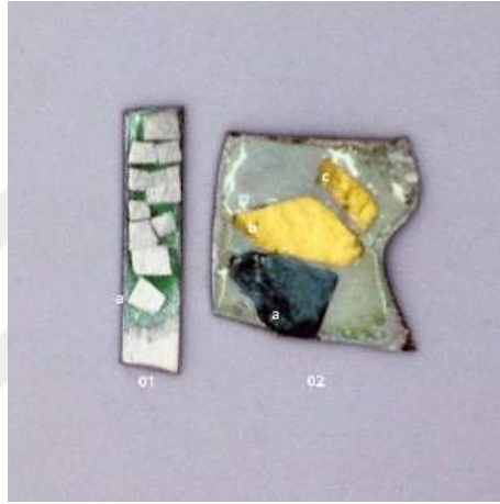
Şekil 70: Mine ile yapıştırma denemeleri
