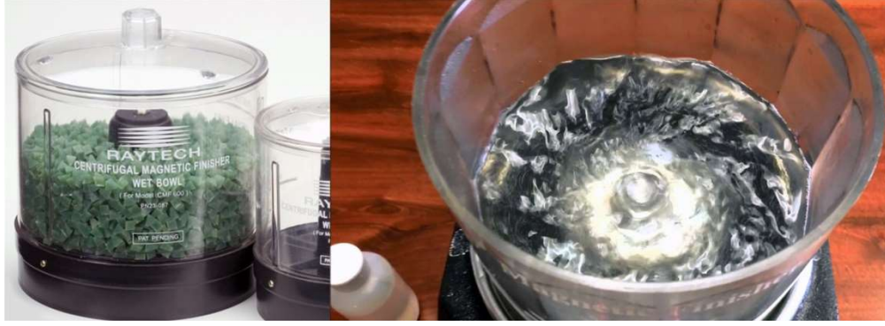
Şekil 49: Magnetik tamburda perdahlama
