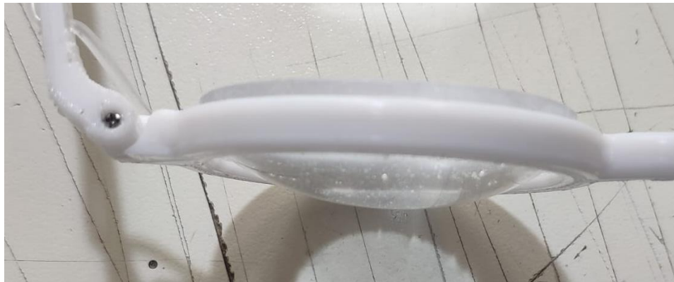
Şekil 4.3. Mercek sıvı dolu halinde.
