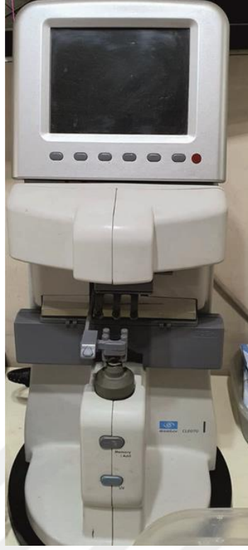
Şekil 5.2. Essilor CLE 070 lensmetre cihazı.
