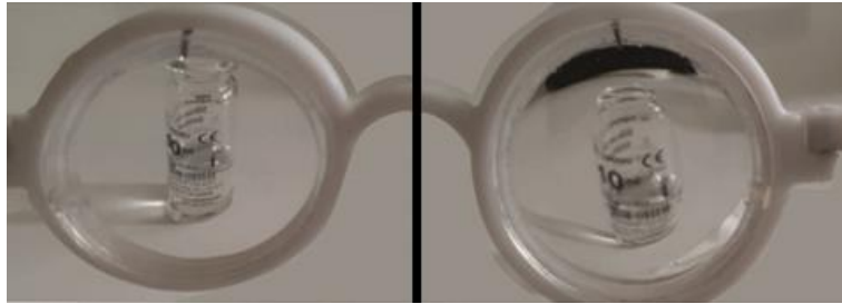
Şekil 5.5. Farklı kırılma derecesiyle sıvı-dolu mercekler.
