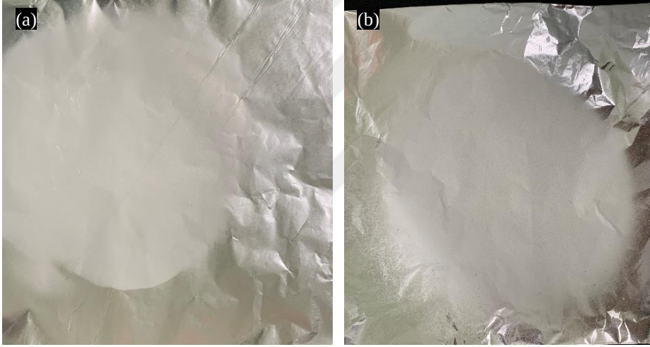
Resim 4.1: Üretilen deri ikamelerinin fotoğrafları: (a) saf PLCL fiber mat; (b) ağırlıkça %5 oranında borik asit içeren PLCL fiber mat
