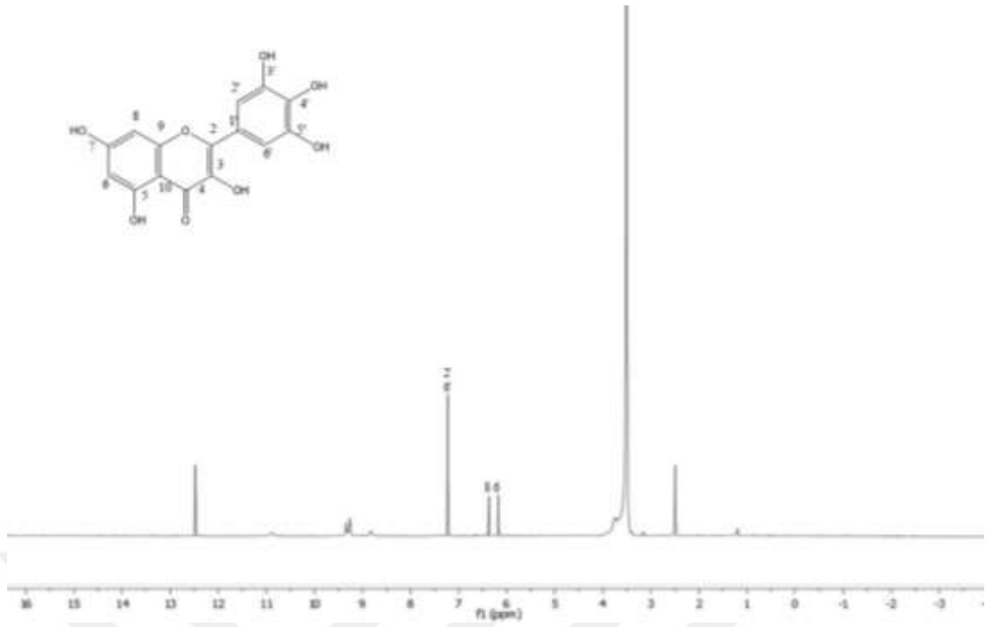
Şekil 4.149. Mirsetin (PME-4)'in ^1\text{H} -NMR ( \text{DMSO-d}_6 , 400 MHz) spektrumu
