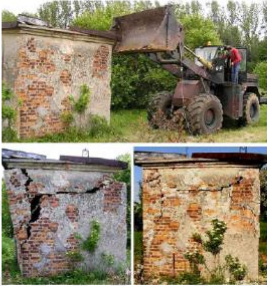
Şekil 1.10. Dozerle yatay yük uygulanan kulübe [15]
