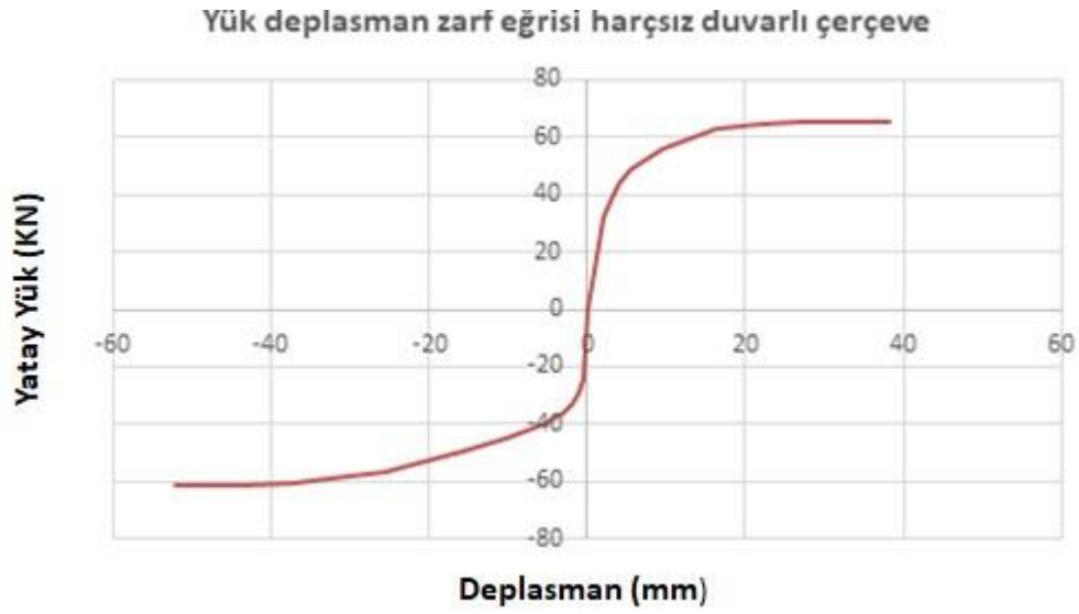
Şekil 3.35. Harçsız duvarlı harçlı birleşimli çerçevenin histerezis eğrisini çevreleyen zarf eğrisi
