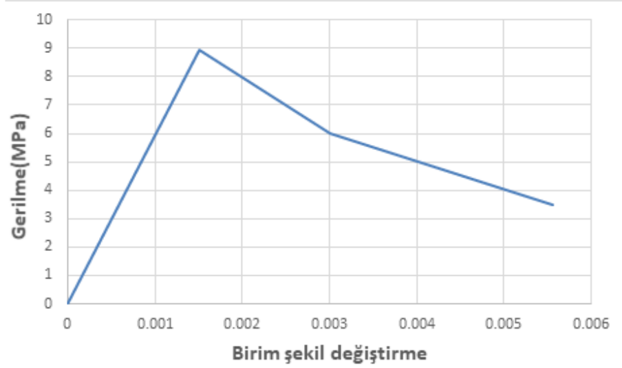
Şekil 4.7 Dolu tuğlanın çekmede gerilme şekil değiştirme ilişkileri
