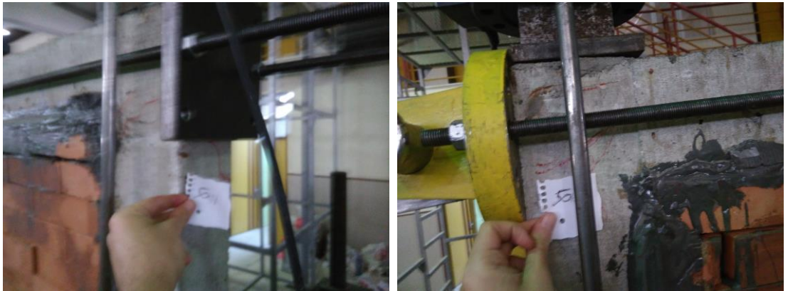
Şekil 3.44. Harçsız duvarlı polimer birleşimli çerçevede 50kN yüklemesindeki hasarlar
