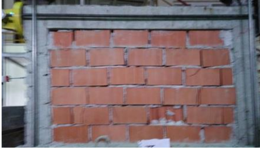
Şekil 3.52. Geleneksel çerçevenin 70kN yüklemesindeki genel durumu
