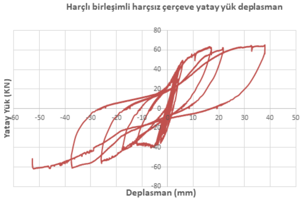
Şekil 3.34. Harçsız duvarlı harçlı birleşimli çerçevede histerezis eğrisi
