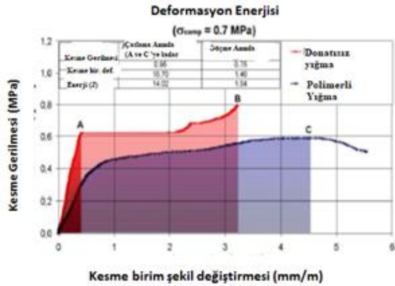
Şekil 1.11 Orijinal ve onarılmış duvarın yatay gerilme-kesme birim şekil değişirme grafiği [15]
