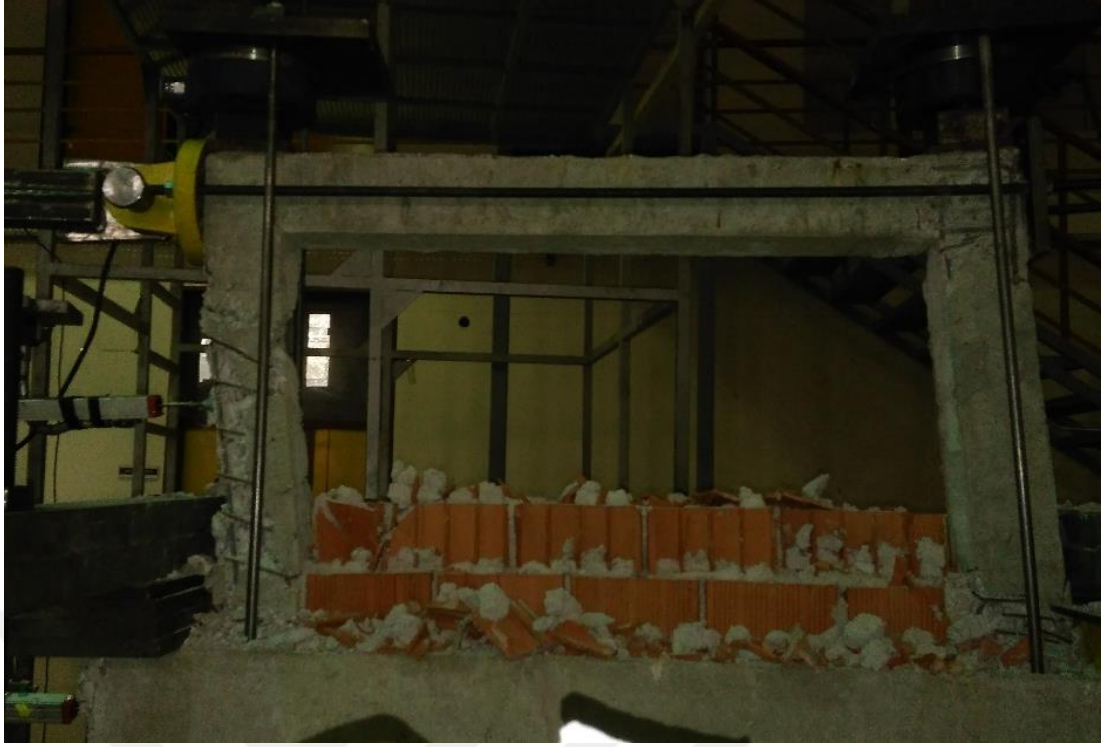
Şekil 3.54. Geleneksel çerçevenin maksimum deplasmandaki durumu
