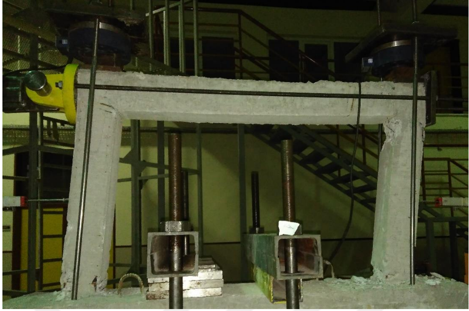
Şekil 3.40. Duvarsız çerçeve 60mm yüklemesinde genel görünüm
