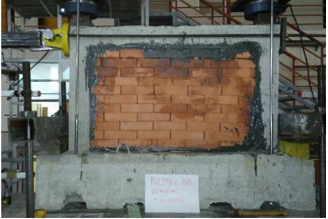
Şekil 3.43. Harçsız duvarlı polimer birleşimli çerçevenin yükleme durumu
