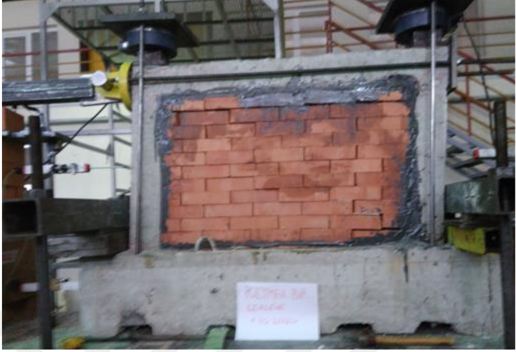
Şekil 3.47. Harçsız duvarlı polimer birleşimli çerçevede 65kN yüklemesindeki genel durumu
