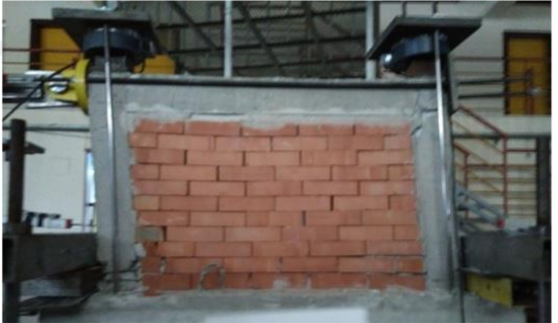
Şekil 3.32. Harçsız duvarlı harçlı birleşimli çerçevede maksimum yükte genel görünüm
