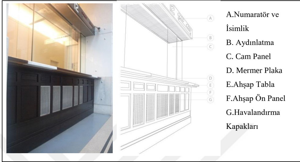
Şekil 32. Gişe Mobilyası Malzeme Şeması (Fotoğraf ve Çizim Rabia Temel, 2019)
