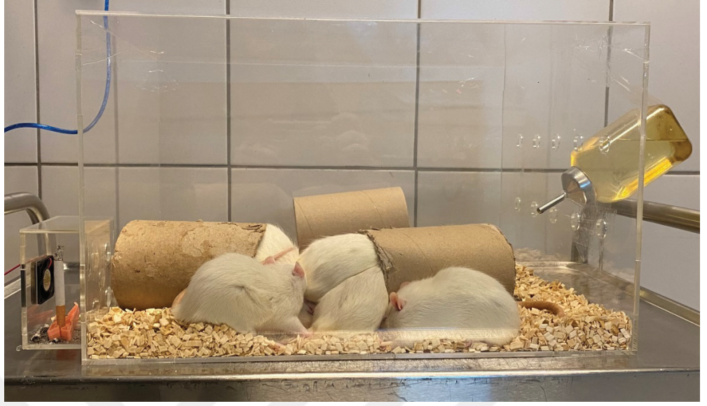
Şekil 3.2: Deney Hayvanlarının Yer Aldığı Sigara Dumanı İnhalasyon Kabini
