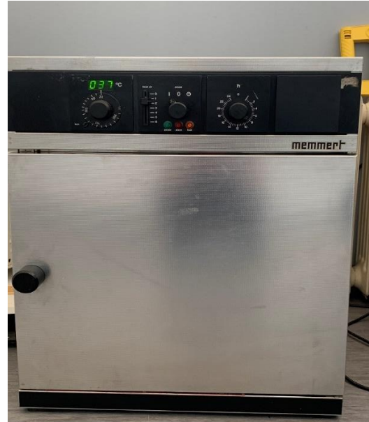
Resim 15: Örneklerin etüve yerleştirilmesi ve örneklerin 37°C' deki etüvde bekletilmesi
