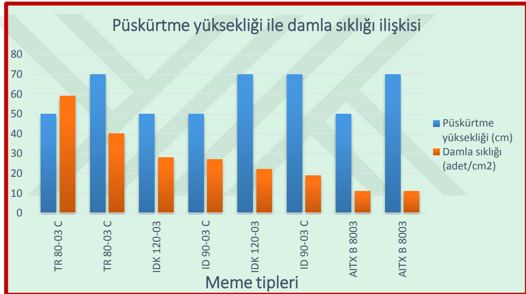
Şekil 4.6. Püskürtme yüksekliklerinde damla sıklık değerleri
