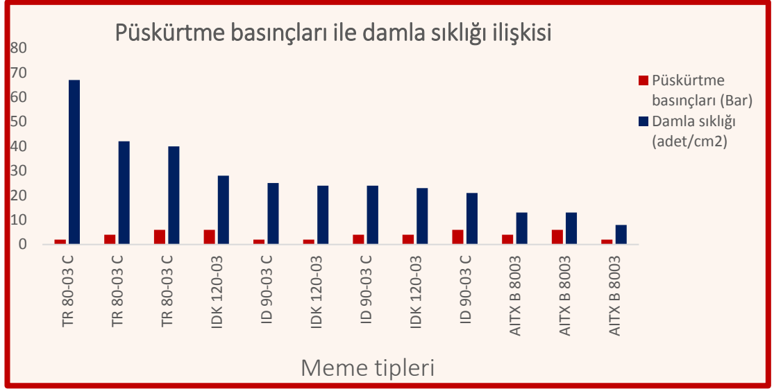
Şekil 4.7. Püskürtme basınçlarında damla sıklık değerleri
