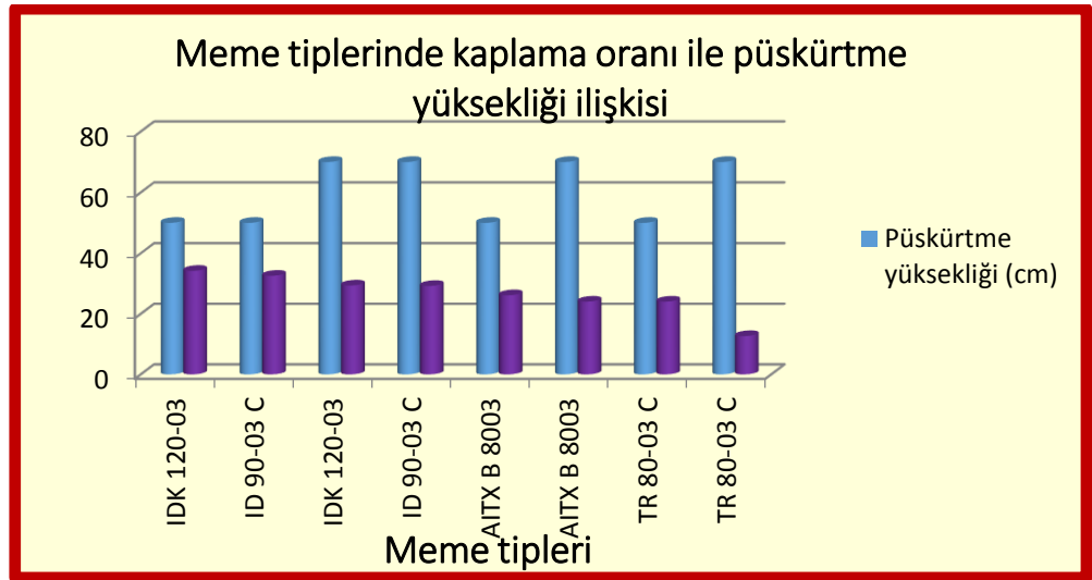
Şekil 4.2. Meme tipleri ile püskürtme yüksekliği ve kaplama oranı ilişkisi
